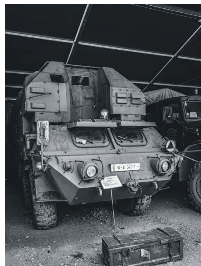
Mobilna stacja rozpoznawania systemów radiolokacyjnych BREŃ-2. Pierwszy z trzech wyprodukowanych prototypów
