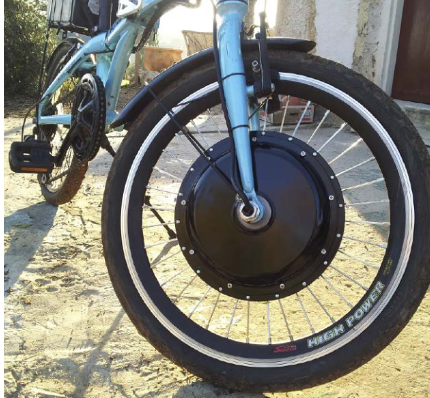
6. Rower elektryczny z silnikiem zamontowanym w przednim kole
