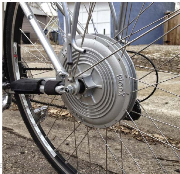
8. Moduł hamowania regeneracyjnego w rowerach BionX
