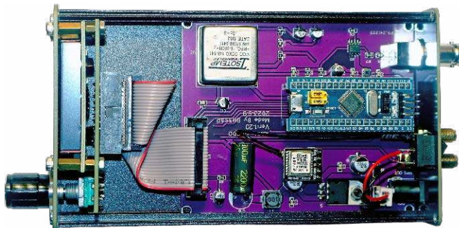
Fotografia 2. Wnętrze generatora wzorcowego. Nieco zaskakuje modułowa konstrukcja, a do tego jeden z modułów nie jest tym, który podaje sprzedawca w specyfikacji urządzenia
