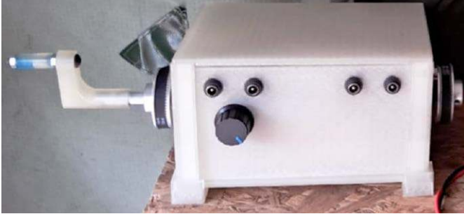
Fotografia 4. Cały RIL bez podłączonych modułów wyjściowych
