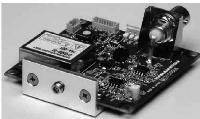
Fotografia 3. Moduł APD typu C10508-01 [1]
