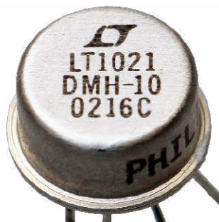
Fotografia 1. Precyzyjne źródło napięcia odniesienia – układ LT1021 w obudowie metalowej ( https://t.ly/gZ5PX )
