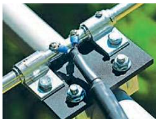
Montaż wibratora do nośnika z uwzględnieniem podłączenia kabla i symetryzatora
