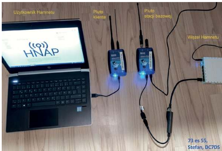
Fot. 2. Łącze z wykorzystaniem radiostacji Adalm Pluto
