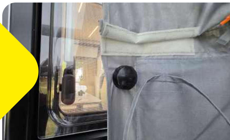
Dometic Limpet Fix Kit pomaga w zamontowaniu przedsionka do ścian kampera; okrągły, obrotowy dodatek w postaci przysawek instalowanych w gotowe otwory przedsionka
