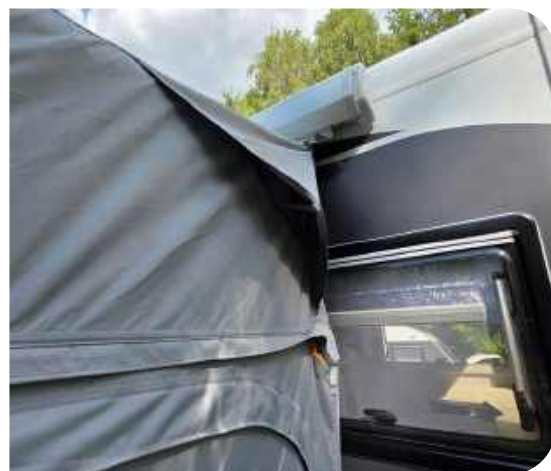
Wentylacja szczytowa to te niewielkie trójkątne szczeliny w miejscu połączenia przedsionka z kamperem; odpowiada za obieg powietrza i zmniejsza kondensację wilgoci
