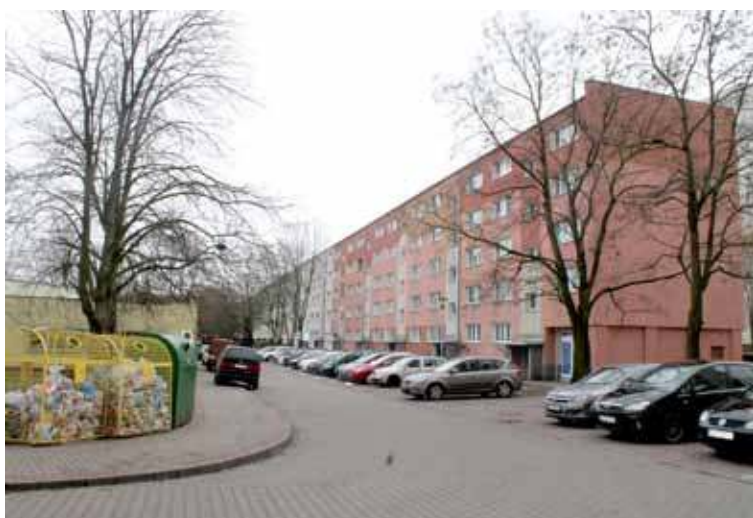
Nie ma też odpowiedniego dostępu przeciwpożarowego do budynku A 10-13, gdyż droga nie jest zakończona placem manewrowym
