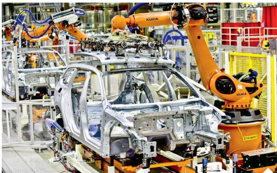
W nowej fabryce Volkswagena w Zwickau elektryczne auta montują roboty | fot. mat. pras./d
