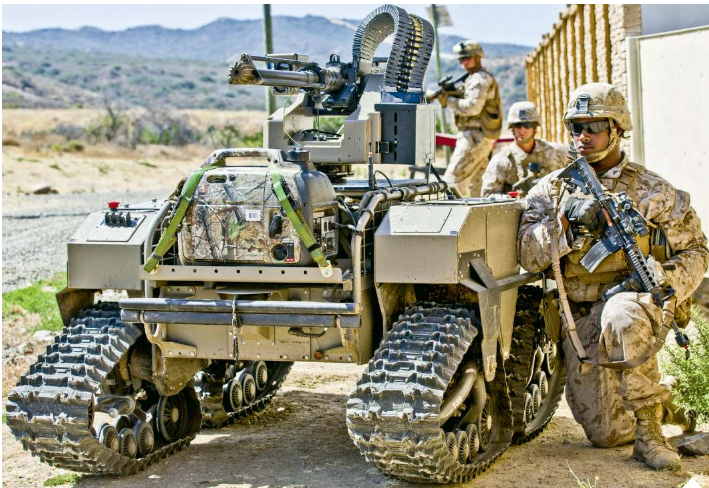
Ten „mechaniczny muł” może być sterowany radiowo na dystansie do 200 m bądź półautomatycznie | fot. mat. pras./d
