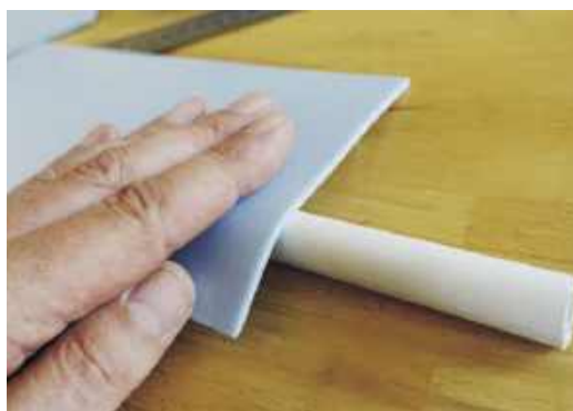
Sposób na wygięcie płaszczyzn nośnych
