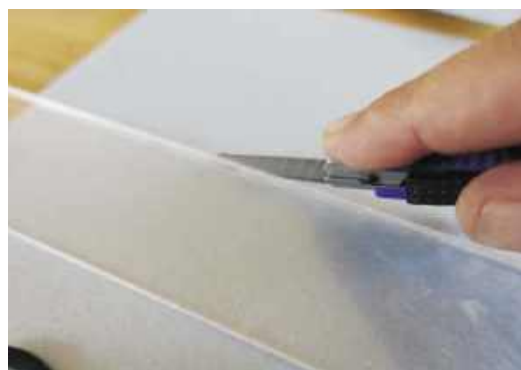
Sposób cięcia pianki
