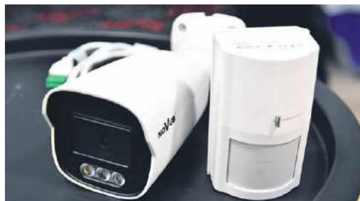
Kamera cyfrowa z obiektywem 2,8 mm z kątem widzenia około 120 stopni. Obok bezprzewodowy czujnik ruchu.
