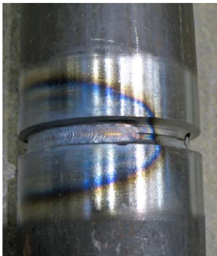
2. Korozja chemiczna wokół spawu spowodowana miejscowym nagraniem stali (źródło: Wikipedia, autor: Yannick Trottier)
