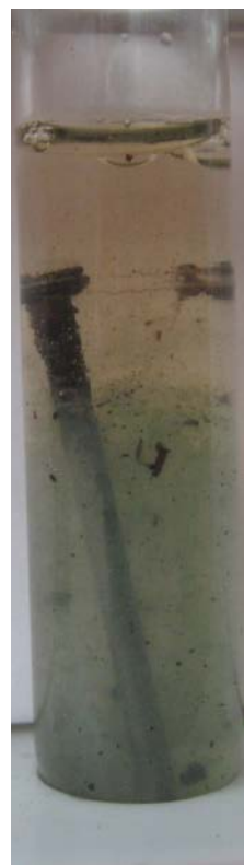
6. Zielonkawy osad wodorotlenku żelaza(III) świadczy o korozji stali w zakwaszonym roztworze (widok po zobojętnieniu kwasu roztworem wodorotlenku sodu)
