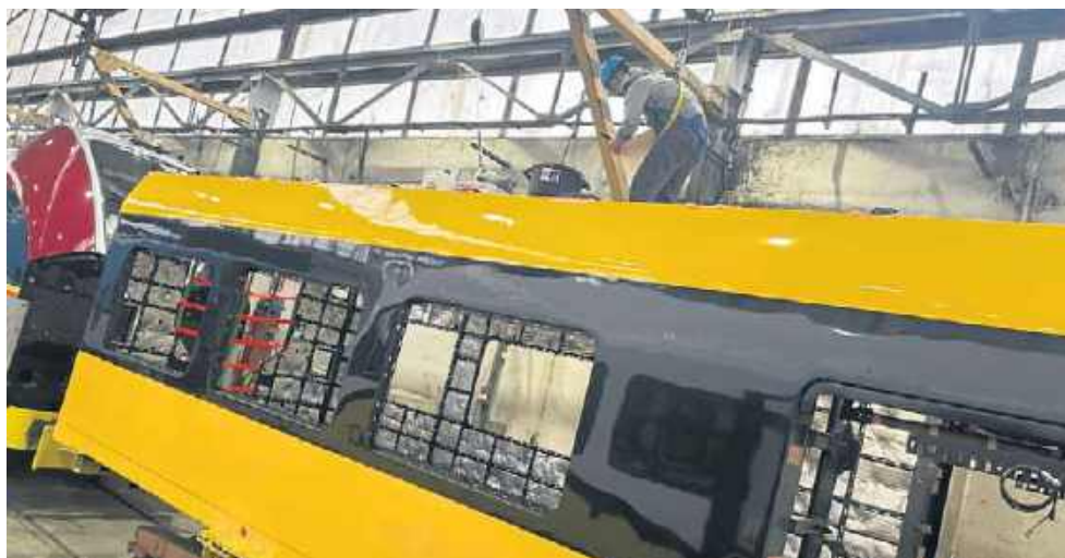
W hali Pesy powstają pociągi dla RegioJet. Obecnie są na różnych etapach zaawansowania produkcji. Gotowy pojazd przechodzi testy homologacyjne w Czechach
