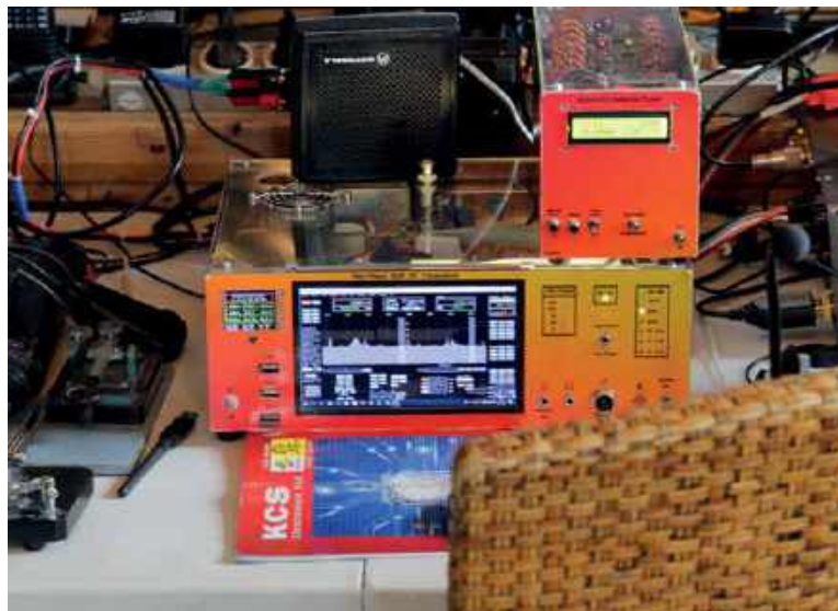
Radio SDR konstrukcji Gerta PE0MGB
