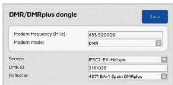
Rys. 1. Konfiguracja połączenia z siecią DMR+
