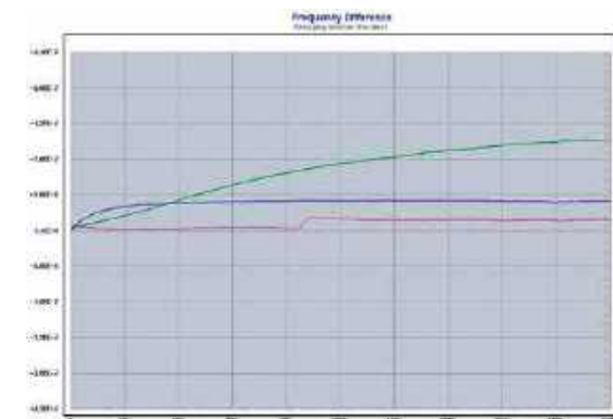
Test stabilności transceiverów: wykres niebieski i czerwony dotyczy IC-9700 (odpowiednio 50 i 1 W), zielony Yaesu FT-991
