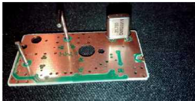
Konwerter MCTV-668 po wymianie rezonatora
