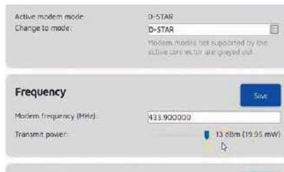
Rys. 3. Konfiguracja modemu D-STAR (fragment okna)
