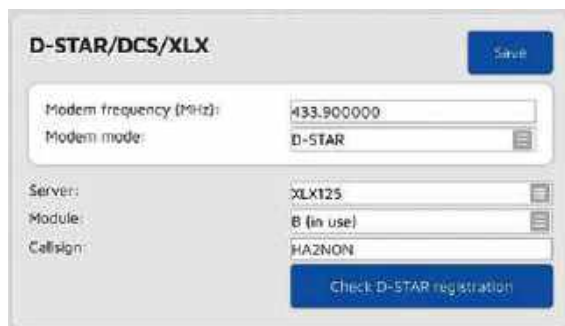
Rys. 2. Konfiguracja połączenia z reflektorami XLX
