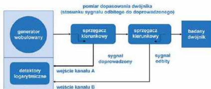
Rys. 1. Zasada pracy urządzenia
