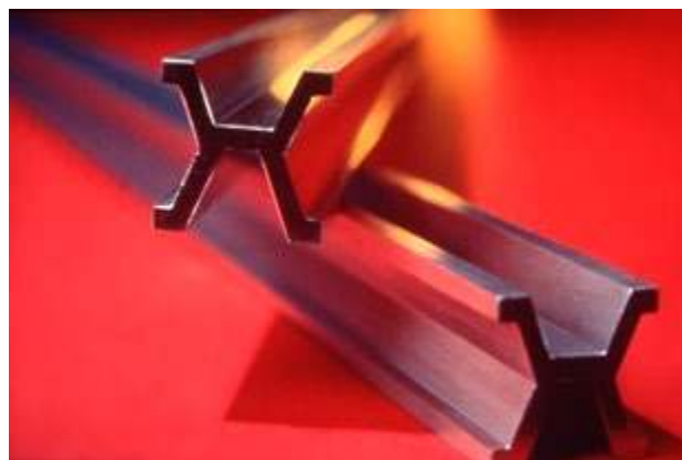
Wzorec metra, pręt o długości wynoszącej 102 cm, w przekroju poprzecznym ma kształt litery „X” i wymiary 16 mm x 16 mm, na którym zaznaczono linie, ( https://pl.wikipedia.org/wiki/Metr )
