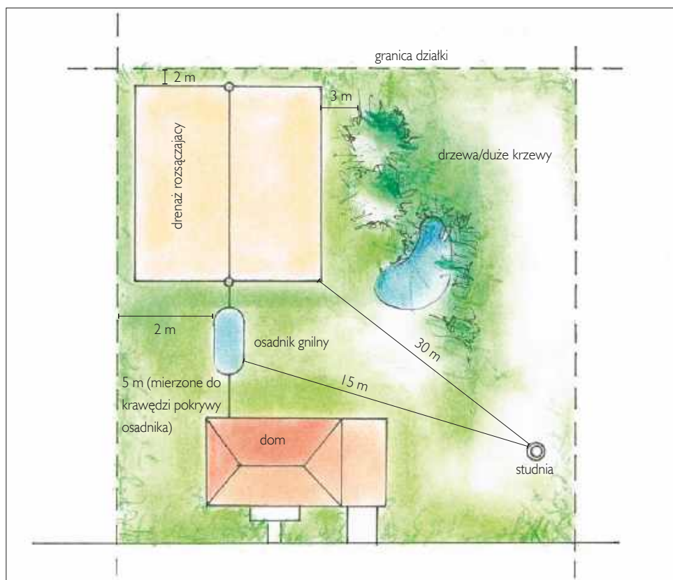
📍 Oczyszczalnia z drenażem – minimalne odległości wymagane prawem.
