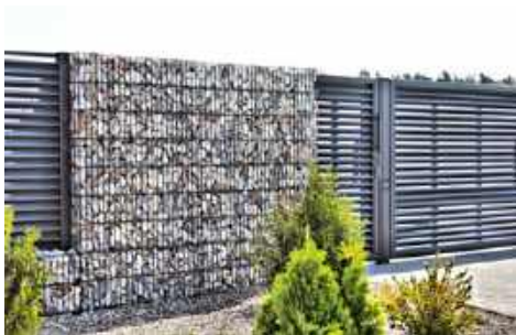
📌 Gabiony to kosze z metalowej siatki, w których umieszcza się kamienie, szkło lub drewno. KONSORT
