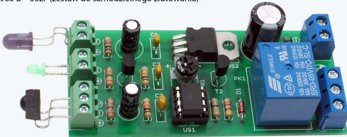
Zdjęcie przedstawia zlutowany moduł włącznika AVT1980
