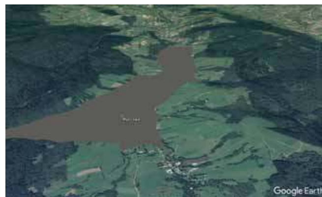
Ryc. 15. Przymierzalny zasięg jeziora zaporowego Kąty-Myscowa przy założeniu, że korona zapory znajdzie się na wysokości 356 m n.p.m.
