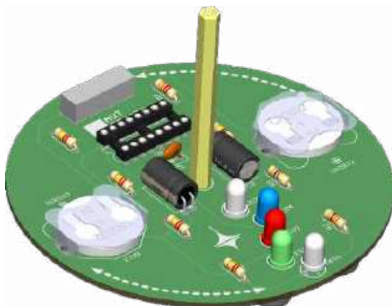
Rysunek 14. Baterie wsunięte do uchwytów. Górne powierzchnie baterii to ich bieguny dodatnie, które mają stykać się z blaszkami uchwytów
