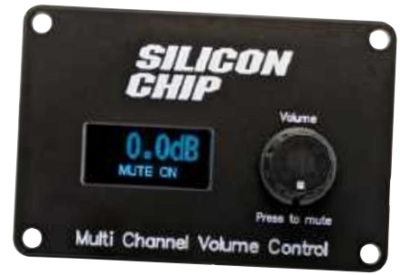
Opcjonalny moduł OLED zapewni bardziej kompaktowy wyświetlacz oraz regulację głośności za pomocą enkodera obrotowego. Jeśli nie chcesz korzystać z ekranu dotykowego, moduł OLED może pełnić rolę głównego interfejsu użytkownika, współpracując z odbiornikiem podczerwiieni podłączonym do modułu sterującego
