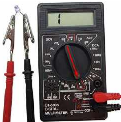
Fotografia 3. Sprawdzanie diody LED za pomocą multimetru ustawionego na funkcję testowania diod. Po przyłożeniu sondy czerwonej do anody, a czarnej do katody, sprawna dioda LED powinna się zaświecić. Jeśli dioda ma odpowiednio długie (jeszcze nie przycięte) wyprowadzenia można się wspomóc krokodylkami
