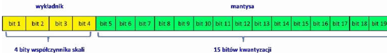
Struktura bitowa kodowania pojedynczej próbki w systemie PASC (© 2020 Jos Verstraten)
