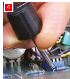
Rysunek 1. Zawsze sprawdzaj co wyrzucasz! Ta drucziana sprężyna do zaston jest przydatna do wszelkiego rodzaju prac – jest wytrzymała i sprężysta; Rysunek 2. Do odizolowanej druczianej sprężyny do zaston przymocowana jest gałka z tulejką o średnicy 4 mm; Rysunek 3. Widok uformowanego haczyka; Rysunek 4. Rezystor można łatwo usunąć z płytki postępując się jedną ręką, pozostawiając drugą ręką wolną do obsługi lutownicy
