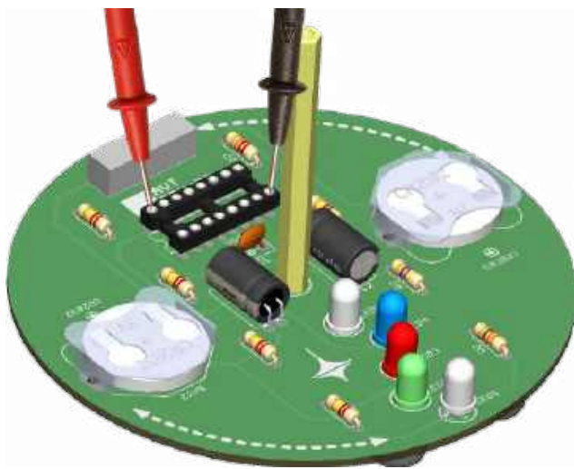
Rysunek 16. Pomiar napięcia zasilania na wyprowadzeniach podstawki pod układ scalony US1. Pamiętaj, aby przed pomiarem zewrzeć wyprowadzenia włącznika SW1 oraz zamontować baterie
