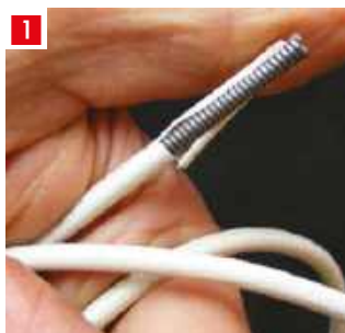
Rysunek 1. Zawsze sprawdzaj co wyrzucasz! Ta drucziana sprężyna do zaston jest przydatna do wszelkiego rodzaju prac – jest wytrzymała i sprężysta; Rysunek 2. Do odizolowanej druczianej sprężyny do zaston przymocowana jest gałka z tulejką o średnicy 4 mm; Rysunek 3. Widok uformowanego haczyka; Rysunek 4. Rezystor można łatwo usunąć z płytki postępując się jedną ręką, pozostawiając drugą ręką wolną do obsługi lutownicy
