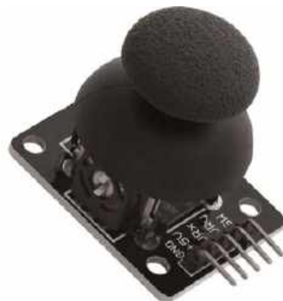
Rysunek 2. Moduł joysticka KY-023. Zdjęcie: AZ-Delivery
