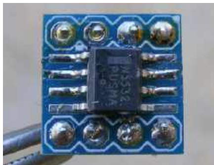
Rysunek 1. Pierwotna inspiracja dla stworzenia adapterów: płytka ze wzmacniaczem operacyjnym SMD-to-DIL firmy HobbyTronics
