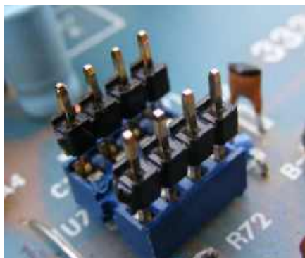
Rysunek 13. Wyprowadzenia adapterów najłatwiej jest lutować po umieszczeniu niezmontowanej jeszcze płytki w podstawie. Utrzymuje to piny w odpowiednim ustawieniu i zapewnia stabilną platformę podczas lutowania elementów adaptera i wzmacniaczy operacyjnych. Zwróć uwagę na układ 8087, który zastąpił TL072 w starym mikserze
