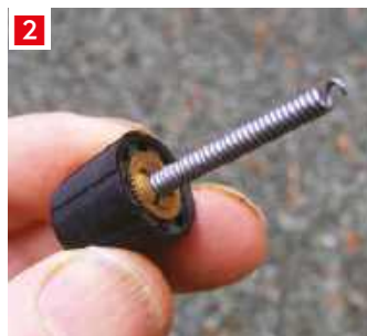
Rysunek 1. Zawsze sprawdzaj co wyrzucasz! Ta drucziana sprężyna do zaston jest przydatna do wszelkiego rodzaju prac – jest wytrzymała i sprężysta; Rysunek 2. Do odizolowanej druczianej sprężyny do zaston przymocowana jest gałka z tulejką o średnicy 4 mm; Rysunek 3. Widok uformowanego haczyka; Rysunek 4. Rezystor można łatwo usunąć z płytki postępując się jedną ręką, pozostawiając drugą ręką wolną do obsługi lutownicy
