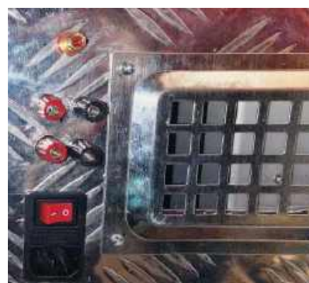
Fotografia 6. Na tylnym panelu znajdują się złącza dla wejścia zasilania (IEC), wejścia sygnału (RCA) i zacisków dla wyjść głośnikowych. Górne gniazda są przeznaczone dla obciążeń 2 Ω i 4 Ω, podczas gdy dolne gniazda zapewniają kompensację częstotliwości dla obciążenia 8 Ω
