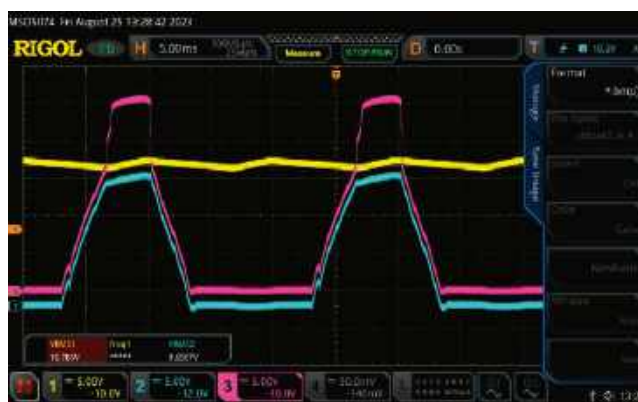
Rysunek 3. Cyjanowy przebieg to dodatni fragment wejściowego napięcia AC, żółty to przefiltrowany przebieg wyjściowy DC, a fioletowy to dodatni przebieg sterujący bramką MOSFET-a. Cyjanowy przebieg AC jest przesunięty o -2 V, w przeciwnym razie fioletowy przebieg zastąpiłby go przez większość czasu
