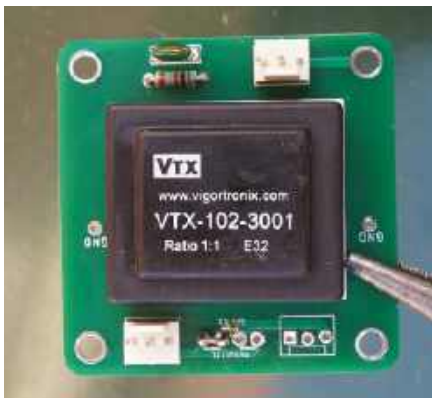
Rysunek 44. Zmontowana płytkę z transformatorem 3001. Elementy w obwodzie Zobla mają wartości 2 kΩ i 8,2 nF
