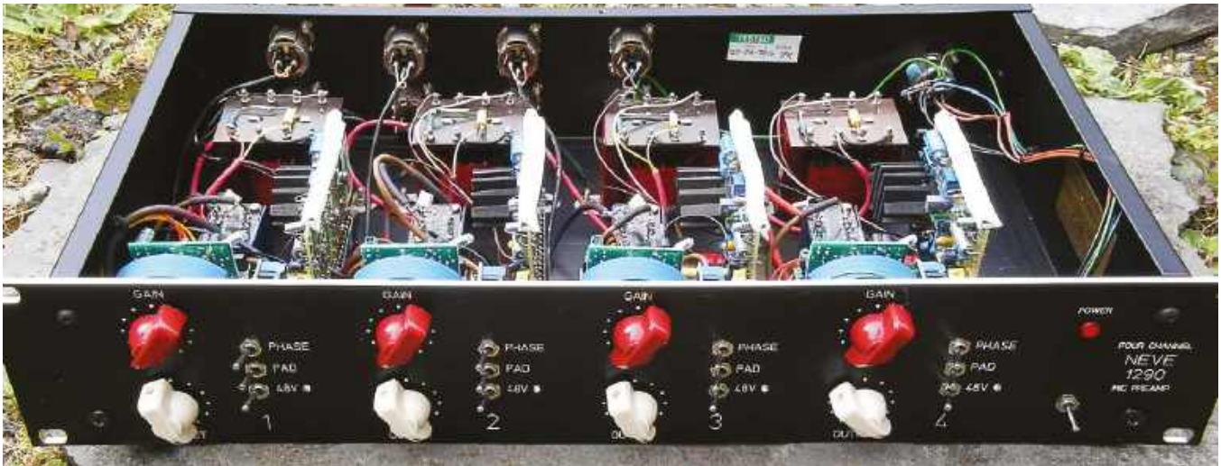
Rysunek 55. Kompletny przedwzmacniacz mikrofonowy „Neve”, zbudowany dla Eda Lewisa ze studia Giant Wafer. Zwróćmy uwagę na rządęk czterech transfor- matorów L01166
