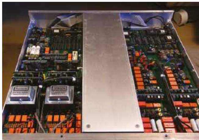
Rysunek 38. Transformatory wyjściowe Jensen, wykonane na zamówienie (u dołu po lewej) w analizatorze Audio Precision SYS-2712. Symetryczne wyjście z transformatora ma najniższe zniekształcenia, z jakimi kiedykolwiek się spotkałem. Musi mieć takie, ponieważ jest to system do mierzenia zniekształceń innych wzmacniaczy
