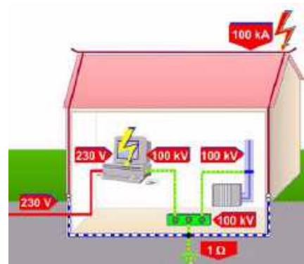
Skutki bezpośredniego uderzenia pioruna (© Stagobel Electro, oprac. 2023 Jos Verstraten)
