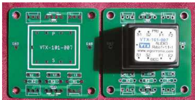
Rysunek 39. Płytki do montowania transformatorów Vigortronix/OEP. Umożliwiają one łączenie szeregowo/równoległe uzwojeń i dodanie obwodów Zobla. Są przystosowane do złączy Molex
