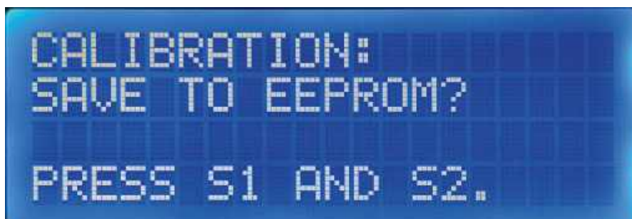
Ekran 3. Współczynniki kalibracji można zapisać w nieulotnej pamięci EEPROM, naciskając jednocześnie przyciski S1 i S2 na tej stronie
