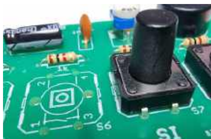
Fotografia 15. Poprawny montaż przycisków dźwięku. Po lewej stronie widoczny jest obrys komponentu. Po prawej – przycisk już zamontowany. Wszystkie nóżki przycisku przeszły przez otwory na PCB, a podstawa przycisku przylega bezpośrednio do powierzchni PCB
