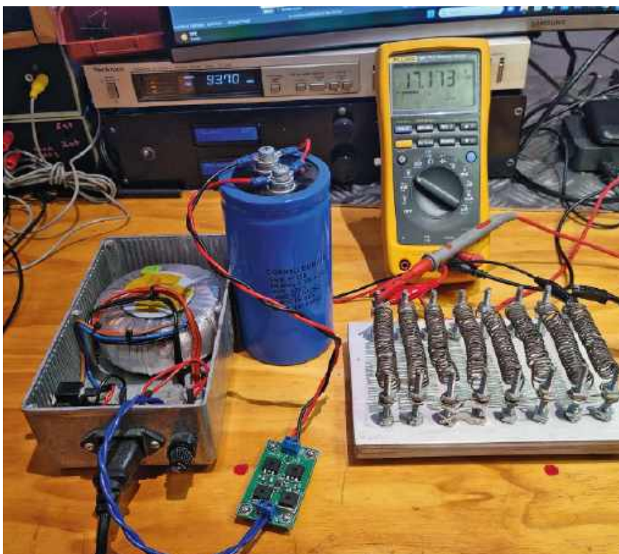
Moje prymitywne obciążenie nichromowe osiągnęło temperaturę 320°C, natomiast MOSFET-y w samodzielnym module D2PAK osiągnęły tylko 67°C
