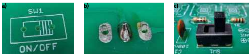
Fotografia 14. a) Sposób oznaczenia miejsca do zamontowania przełącznika SW1 na płytce drukowanej; b) zanim przylutujesz wszystkie wyprowadzenia, przylutuj w pierwszej kolejności pin środkowy i sprawdź, czy komponent przylega prostopadle do płytki. Jeśli wszystko jest w porządku przylutuj dwa pozostałe wyprowadzenia; c) tym sposobem przełącznik został poprawnie przylutowany i dobrze przylega do płytki
