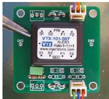
Rysunek 42. Płytkę wzmacniacza z wyjściem liniowym z transformatorem VTX-101-007 o uzwojeniach połączonych równoległe. Elementy obwodu Zobla to 1,3 kΩ i 6,8 nF
