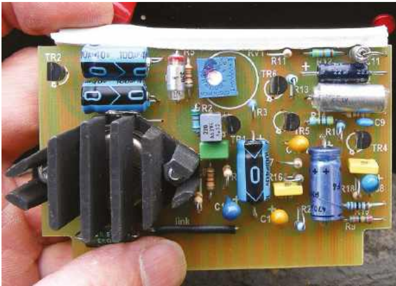
Rysunek 54. Płytkę wzmacniacza Neve BA238. Zwróćcie uwagę na tranzystor sterujący w obu- dowie TO3. „Nadmierna inżynieria”; układ odporny na nalot bombowy – ale brzmiący znakomicie
