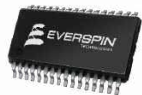
Rysunek 16. Komercyjna pamięć MRAM Everspin z interfejsem równoległym, w 32-pinowej obudowie SOIC. Jest dostępna z interfejsem 8- lub 16-bitowym, ma pojemność od 256 kb do 32 Mb i zachowuje dane przez ponad 20 lat
