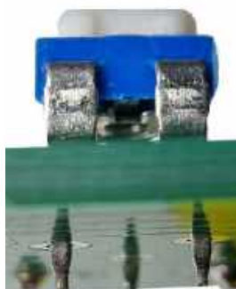
Fotografia 9. a) Prawidłowo zamontowany do płytki potencjometr PR1; b) po dociśnięciu potencjometru do płytki wszystkie trzy jego wyprowadzenia powinny wystawać po stronie lutowania na tę samą długość
