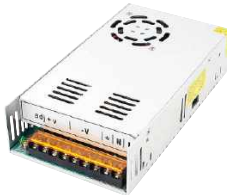
Fotografia 3. Sześć zasilaczy impulsowych zapewnia moc wyjściową ponad 1 kW przy obciążeniu 2 \Omega – trzy po stronie dodatniej i trzy po stronie ujemnej. Każdy z nich ma własny wentylator chłodzący i zabezpieczenie przed przeciążeniem, są wydajne i ekonomiczne. Ich napięcia wyjściowe są również regulowane
