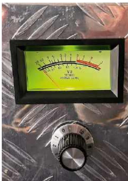
Fotografia 4. Opcjonalny wskaźnikysterowania informuje o aktualnym poziomie wyjściowym sygnale
