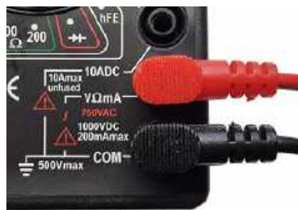
Fotografia 17. Poprawne podłączenie kabli na przykładzie multimetru DT-830B, ustawionego na funkcję woltomierza napięć stałych
