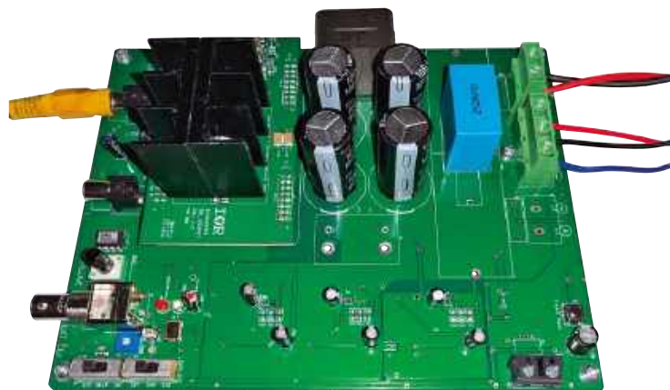
Fotografia 1. Gotowy moduł monofonicznego wzmacniacza klasy D IRAUDAMP9. Pomimo względnej złożoności układu, korzystanie z niego jest w rzeczywistości dość łatwe
