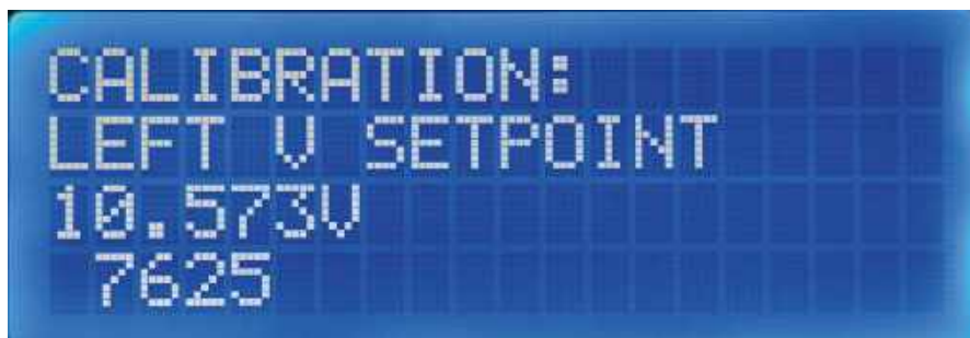
Ekran 2. Wszystkie główne parametry wyświetlane na ekranie głównym można skalibrować za pomocą tych ekranów. Wystarczy odczytać rzeczywiste napięcie za pomocą multimetru i użyć przycisków S1 i S2, aby dostosować wyświetlane napięcie, aż będzie zgodne z rzeczywistym
