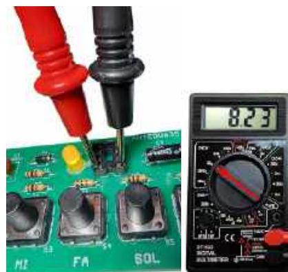
Fotografia 18. Pomiar na zaciskach 8 („plus”) i 1 („minus”) podstawki pod układ NE555 wskazał poprawne napięcie baterii (bez znaku „-”, który sugerowałby błędną polaryzację), pomniejszone o spadek napięcia na diodzie D1. Można teraz odłączyć zasilanie i zamontować układ NE555 w podstawce
