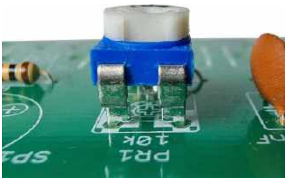
Fotografia 9. a) Prawidłowo zamontowany do płytki potencjometr PR1; b) po dociśnięciu potencjometru do płytki wszystkie trzy jego wyprowadzenia powinny wystawać po stronie lutowania na tę samą długość
