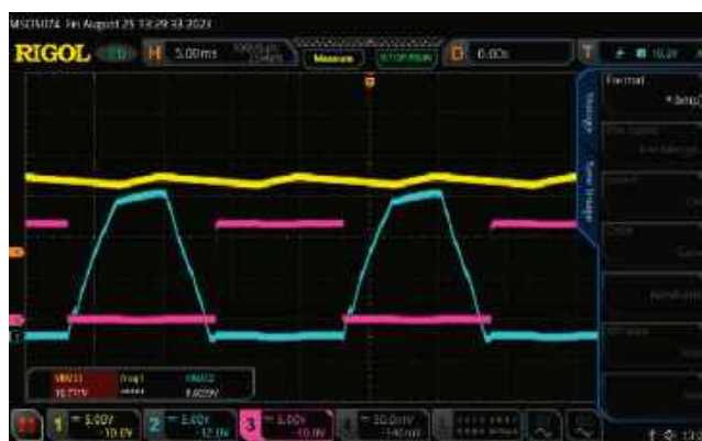
Rysunek 4. Konfiguracja podobna do tej z rysunku 2, ale tym razem monitorujemy bramkę jednego z MOSFET-ów low-side (fioletowy). Widać, że jest on włączony z wypełnieniem zbliżonym do 50%, zsynchronizowanym z przejściami przez zero przebiegu AC
