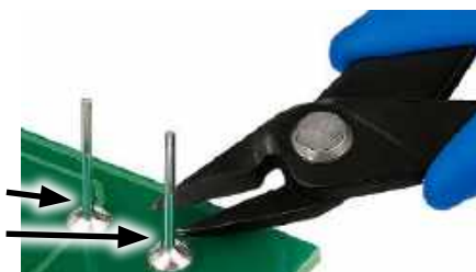
Rysunek 4. Właściwe miejsce cięcia nadmiaru wyprowadzeń po przylutowaniu komponentu. Po wykonaniu cięcia spoina powinna pozostać nienaruszona
