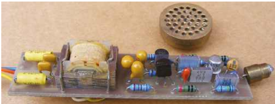
Rysunek 46. Przedwzmacniacz wbudowany do niewielkiego mikrofonu pojemnościowego. Zwróćmy uwagę na transformator wyjściowy. Jego rdzeń składa się tylko z blach „E”
