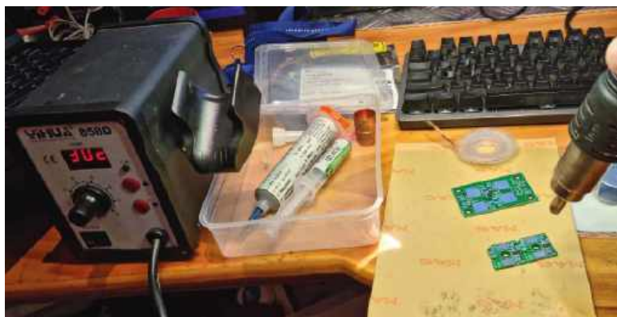
Lutowanie układu scalonego MSOP-12 LT4320 przy użyciu taniej stacji lutowniczej na gorące powietrze. Jest ona nieoceniona przy różnego rodzaju pracach, szczególnie utraty rozlutowywanie układów SMD. W tym przypadku wymarzoną cechą jest możliwość podgrzania układu scalonego na tyle, aby przylutować jego termiczny pad do płytki
