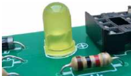
Fotografia 11. Przykład poprawnie zamontowanej diody LED. Płaskie ścięcie na obwodzie diody LED, symbolizujące katodę, musi pokrywać się z fragmentem linii prostej w obrysie komponentu zaznaczonej na płytce
