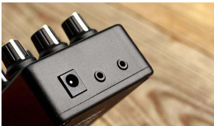
Obok gniazda zasilacza umieszczono miniaturowe złącza jack 2,5 mm służące do wysyłania i odbierania komunikatów MIDI za pomocą specjalnych przejściówek.
