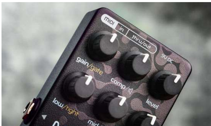
Potencjometry pracują z wyraźnie wyczuwalnym oporem, a ich gałki zapewniają dobry chwyt, ponieważ zostały wykonane z miękkiego tworzywa sztucznego.
