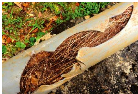
Rury uszkodzone przez korzenie drzewa
