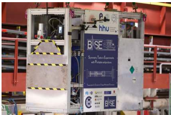
Przenośna kriogeniczna pułapka Penninga na antymaterię, wykorzystana w eksperymencie BASE-STEP
