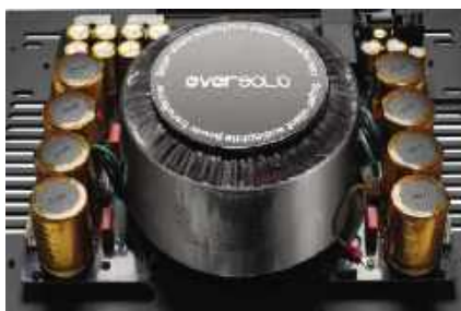
Transformator toroidany jest pojedynczy i obsługuje obydwa kanały, ale płytki stopni wyjściowych są niezależne.
