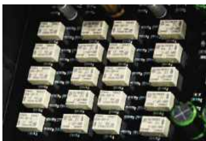
EverSolo samodzielnie zaprojektowało drabinkowy system analogowej regulacji głośności.
