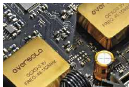
Złote osłony kryją precyzyjne układy zegarów taktujących.
