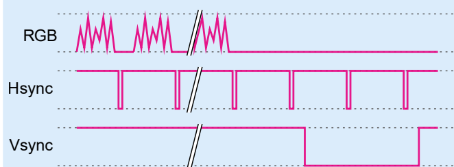
Rysunek 6. Synchronizacja pionowa (Vsync)
