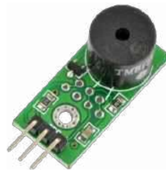
Fotografia 3. Moduł buzzera z generatorem MOD-04526 [9]
