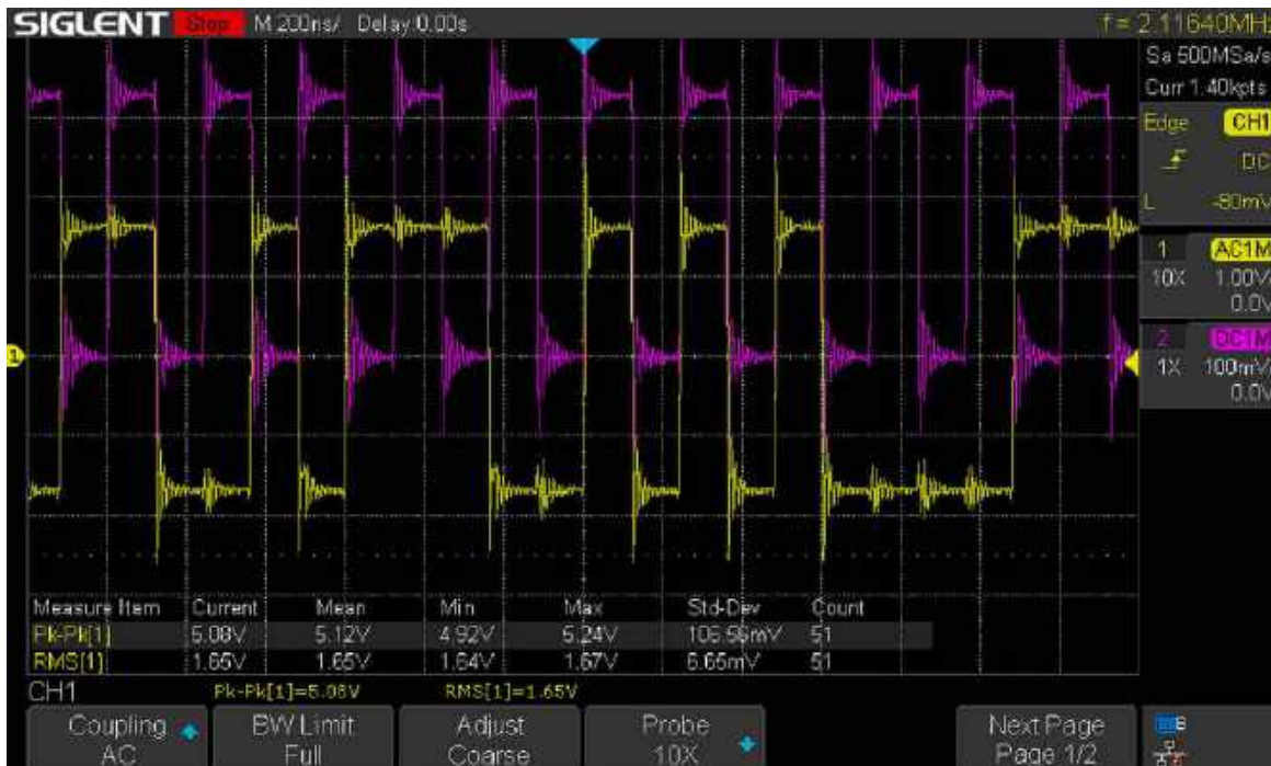
Rysunek 1. Zrzut ekranu z oscyloskopu demonstrujący sygnały wygenerowane przez Tang Primer 25k
