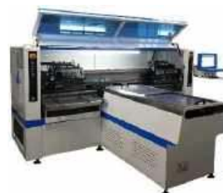
Fotografia 11. Automat do montażu diod LED o teoretycznej wydajności 250 000 CPH ( https://t.ly/GEupw )
