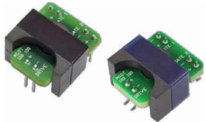
Fotografia 6. Przykład transformatorów planarnych do montażu THT i SMD [9]
