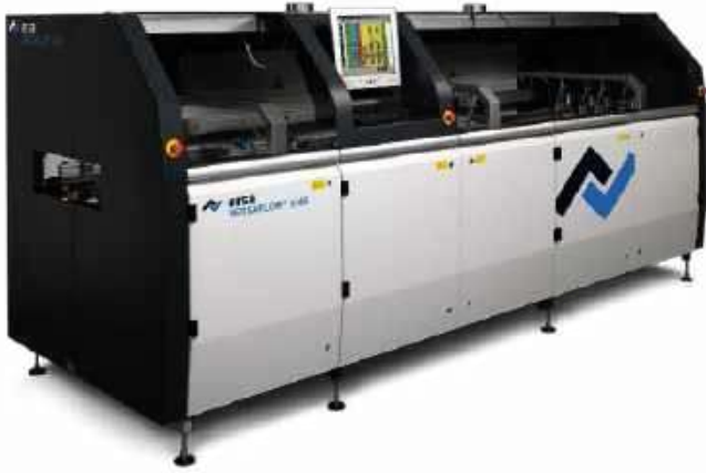
Fotografia 21. Przemysłowy automat do lutowania selektywnego Ersy VERSAFLOW 3/45 – modułowy system z wieloma modułami pokrywania topnikiem, podgrzewania i lutowania (możliwość jednoczesnego lutowania kilkoma dyszami) – https://t.ly/UCrTD
