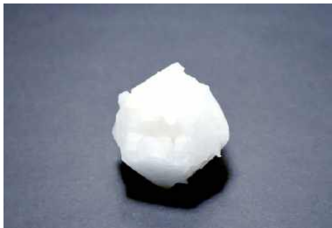
Fotografia 4. Udany model z nylonu PA12 – dwunastościan z zębatek
