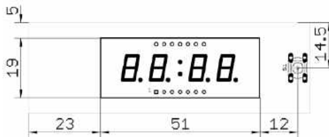
Rysunek 3. Położenie przycisku i wyświetlacza LED na powierzchni płytki drukowanej
