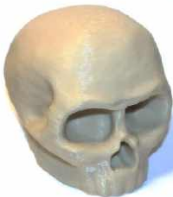
Fotografia 1. Model wydrukowany na K1 Max filamentem PLA+ w kolorze imitującym starą kość
