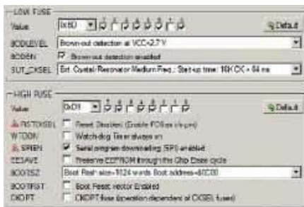
Rysunek 4. Szczegóły ustawienia bitów zabezpieczających
