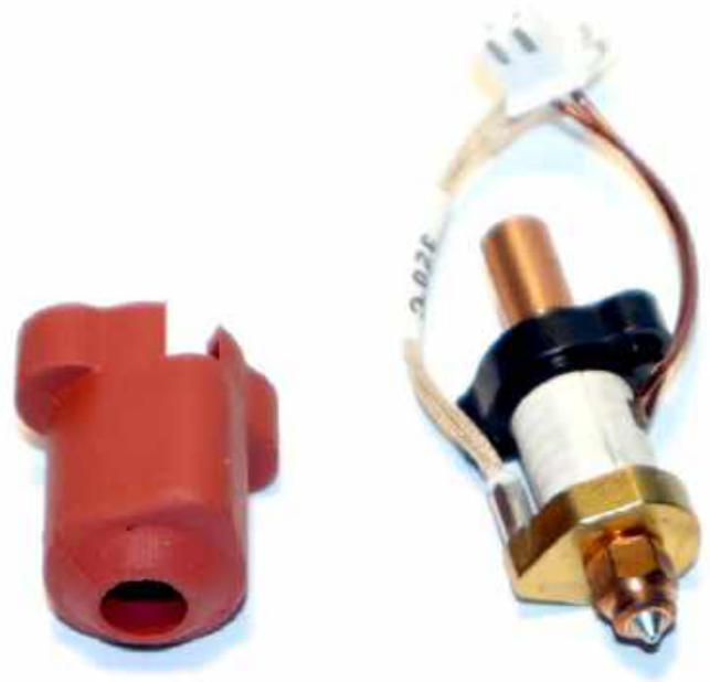
Fotografia 5. Zapasowa grzałka z dyszą, gardzielą i osłoną z silikonu
