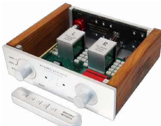
Fotografia 4. Układ regulacji głośności z transformatorem obsługiwany przez przekaźniki [5]
