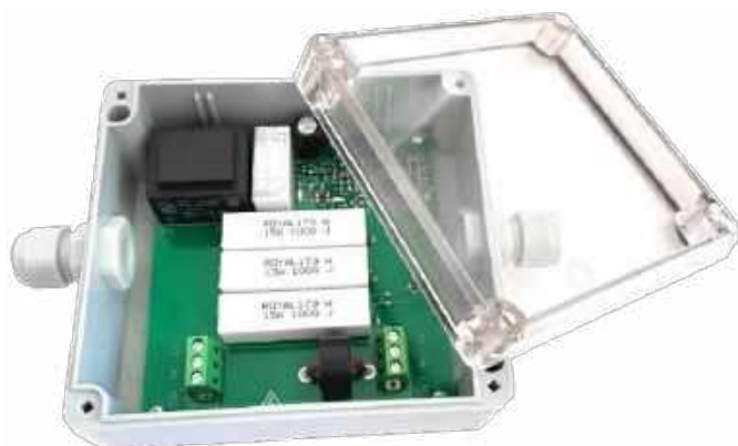
Fotografia 2. Prosty soft-start do urządzenia sieciowego [2]
