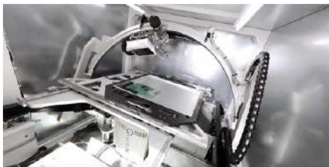
Fotografia 20. Wnętrze maszyny QUADRA 7 Pro marki Nordson ( https://t.ly/VThh7 )
