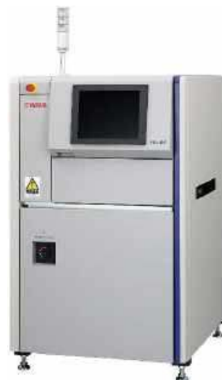
Fotografia 2. System optycznej inspekcji pasty lutowniczej Yamaha YSI-SP ( https://t.ly/SjPTA )
