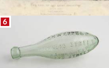
5. Wnętrze Pałacu Kryształowego w Londynie – ilustracja z czasów wielkiej wystawy; 6. Butelka wyprodukowana przez dziewiętnastowieczną maszynę firmy Ashley; 7. Szkło typu wired cast; 8. Produkcja tafli szklanych metodą Fourcaulta; 9. Produkcja tafli szklanych w kąpeli cynowej metodą Alastaira Pilkingtona
