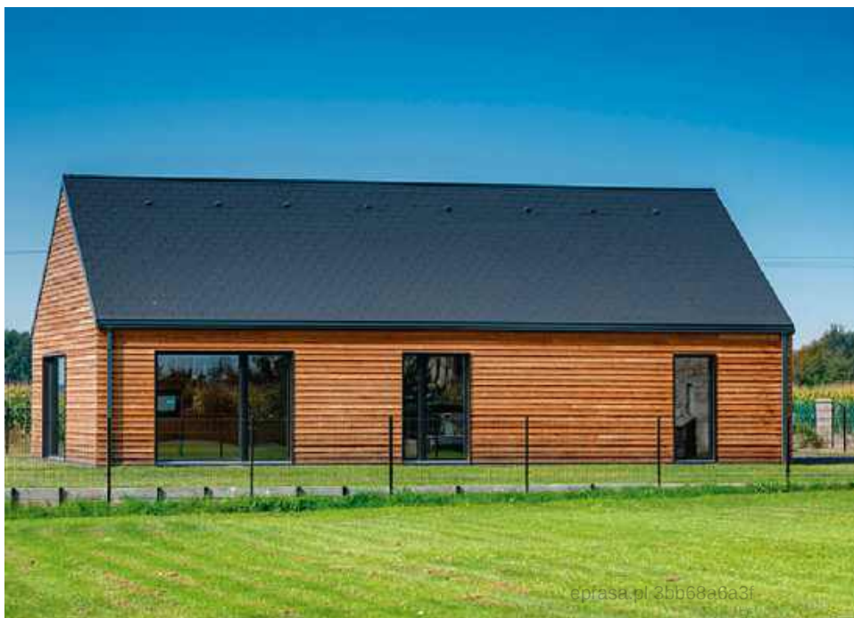
❷ Gonty bitumiczne są lekkie, stosunkowo trwałe i łatwe w obróbce. TEGOLA
