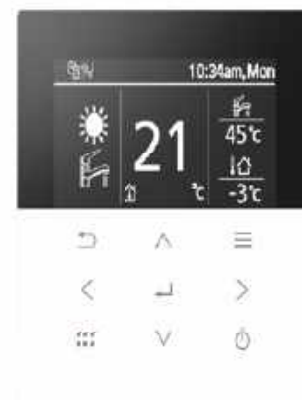
📍 Pompa powinna przygotowywać wodę o jak najniższej temperaturze. PANASONIC
