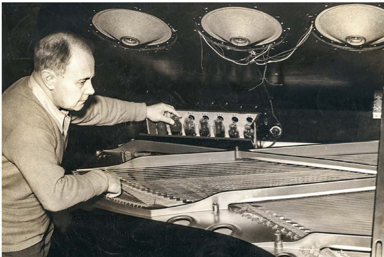
Hofmann testuje opracowany przez siebie wzmacniacz dźwięku fortepianu, zdjęcie niedatowane
