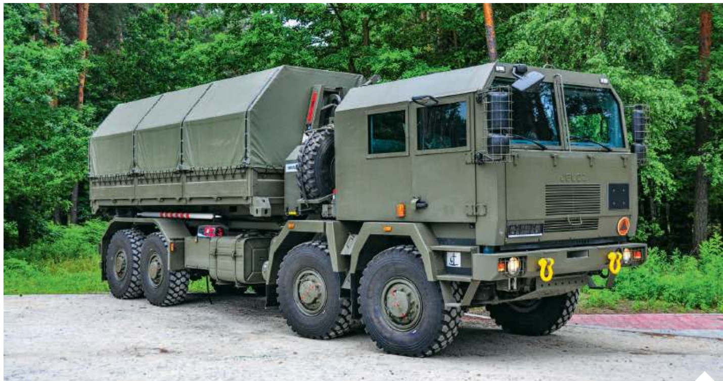
Artyleryjskie wozy amunicyjne mają opancerzoną kabinę, która zapewni osłonę załogi przed pociskami | fot. Wikipedia/d
