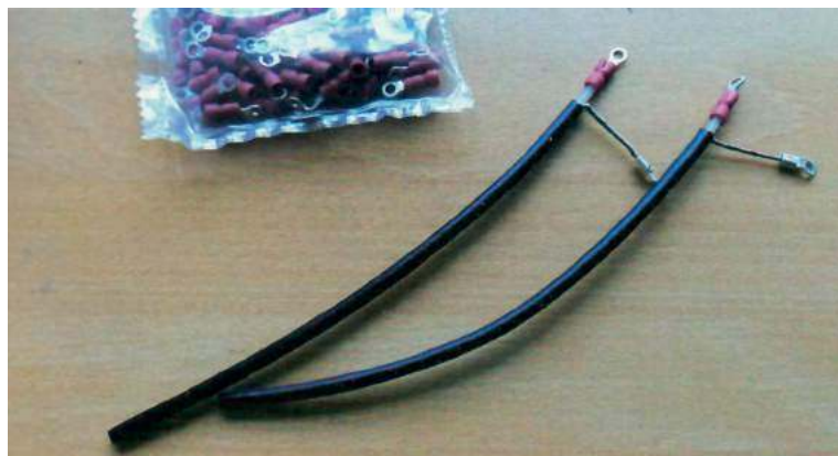
Fot. 2. Wykonanie kondensatorów koncentrycznych
