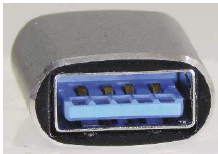
Wyraźnie widać pięć nowych styków (z przodu) i niebieski kolor izolacji tego gniazda USB 3.0
