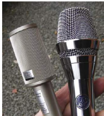
Rysunek 3. Tani mikrofon Sony F-99A 200 Ω (po lewej) nie nadawał się wcześniej do użytku ze standardowymi przedwzmacniaczami mikrofonowymi, a nawet dobry mikrofon wokalny do występów na żywo AKG D7 LTD 600 Ω wymagał dodatkowej charakterystyki wysokich częstotliwości. Obydwa dobrze działają z użyciem odpowiedniego przedwzmacniacza, takiego jak ten, który będziemy budować w przyszłym miesiącu
