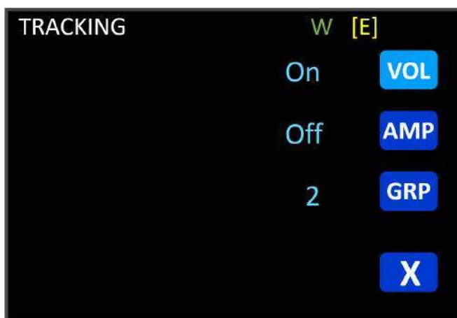
Ekran 6. Ekran śledzenia pozwala przypisać zasilacz do grupy śledzenia (GRP), a następnie ustawić, czy śledzi on napięcie, prąd lub obie wartości innych urządzeń w grupie
