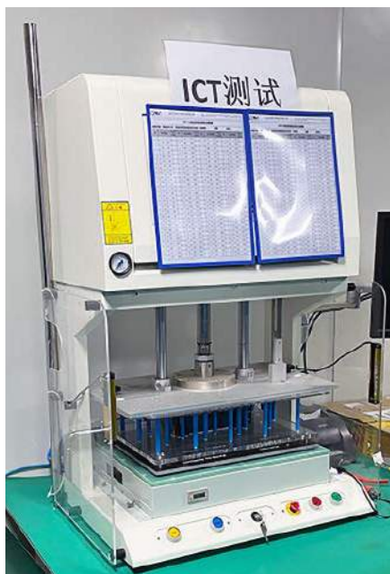
Fotografia 2. Stacja testowa ICT
