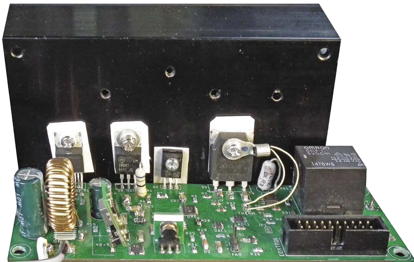
Ukończony prototypowy moduł regulatora przymocowany do radiatora, który został wykorzystany ponownie z innego projektu (stąd dodatkowe otwory). Zwróć uwagę na podkładki izolacyjne pod obudowami podzespołów i plastikowe tuleje pod śrubami montażowymi. Jeśli używasz podkładek mikowych, dodaj pastę termoprzewodzącą po obu stronach. Przed włączeniem zasilania należy sprawdzić, czy istnieje izolacja między każdym radiatorem a odsonionym metalem na radiatorze
