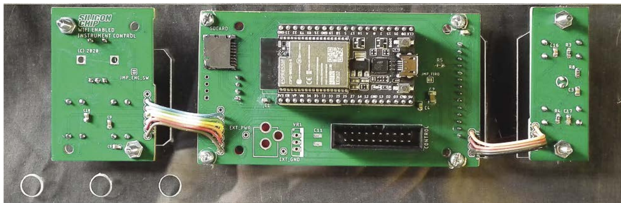
Aby zapewnić lepszy układ panelu przedniego, płytkę sterowania w prototypie Silicon Chip-a została podzielona na trzy części i połączona tęczowymi kablami. Przedstawione tutaj rozwiązania montażowe wykorzystują kawałek przezroczystego pleksiglasu (na górze), który nie jest wymagany do ukończenia projektu wg opisu w tekście artykułów
