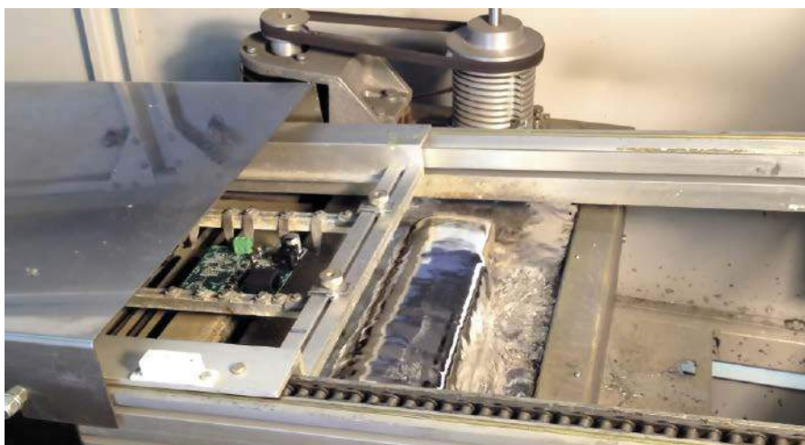
Przykład lutowania na fali pokazujący płytke PCB opuszczającą część grzewczą maszyny i przenoszoną do wanny z falą lutowniczą. Źródło zdjęcia: https://youtu.be/VWH58QrprVc
