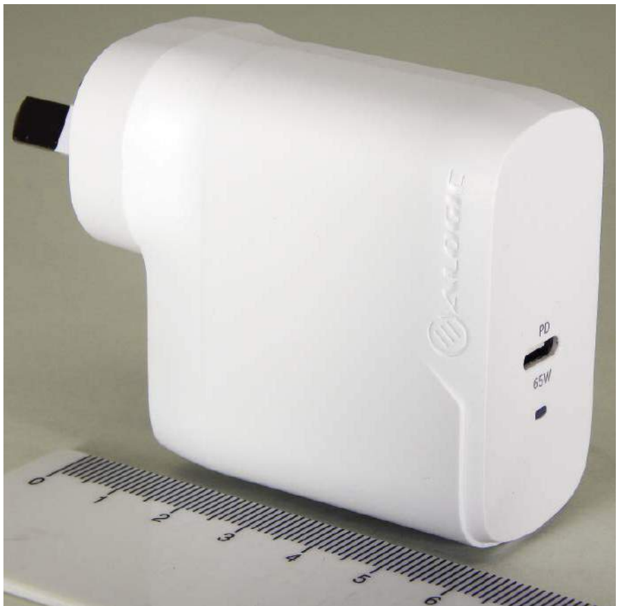
Ładowarka ścienna ALOGIC WCG1X65-ANZ 65 W, pokazana w powiększeniu dla lepszej widoczności. Rejestruje się jako urządzenie zgodne z PD 3.0, a zatem może dostarczać standardowe napięcia 5 V, 9 V, 12 V, 15 V i 20 V przy 3 A (lub 3,25 A dla 20 V). Wraz ze wzrostem mocy wyjściowej, ładowarki te mogą stać się dość kosztowne
