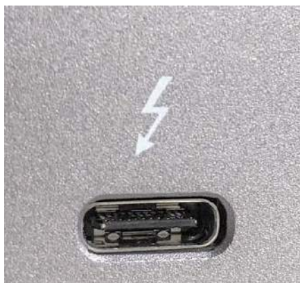
Thunderbolt 3 (na fotografii pokazane gniazdo) wykorzystuje kable z wtyczką USB typu C, ale zapewnia więcej funkcji niż tylko przenoszenie danych; oferuje również większą moc zasilania niż USB (np. do ładowania laptopów) i może transmitować wideo, a nawet sygnały złącza PCI Express. USB 4.0 zasadniczo implementuje funkcje Thunderbolt do standardu USB (fot. https://w.wiki/o27 )
