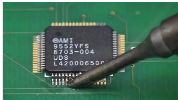
Podczas lutowania metodą przeciągania lutu zazwyczaj używa się grotu typu flow lub grotu skośnego. Najłatwiejszym sposobem na nauczenie się lutowania metodą przeciągania byłoby obejrzenie filmu, takiego, jakich wiele można znaleźć na YouTube Źródło: https://youtu.be/nyele3C1s-U
