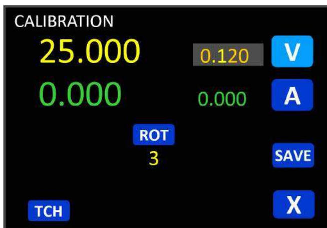
Ekran 4. Ekran kalibracji pokazuje odczyty napięcia i prądu urządzenia w lewym górnym rogu, z regulowanymi przesunięciami kalibracji po ich prawej stronie. Przyciski zapisywania i anulowania znajdują się w prawym dolnym rogu, przycisk obracania ekranu pośrodku, a przycisk menu kalibracji dotykowej w lewym dolnym rogu. (Dostęp do wszystkich pozycji menu uzyskuje się poprzez naciśnięcie przycisków, które w razie potrzeby pojawiają się na dole)
