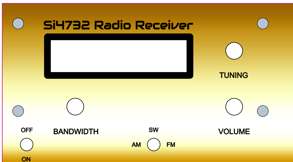
Rysunek 8 i 9. Te etykiety na panel przedni są również dostępne do pobrania ze strony internetowej Silicon Chip-a, dzięki czemu można je wydrukować, wyciąć i przymocować do wewnętrznej (lub zewnętrznej) strony pokrywy obudowy
