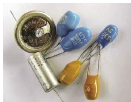
Rysunek 7. Kondensatory tantalowe oferują wysokie wartości pojemności przy niskich prądach upływu (10...20 µA) – chociaż producenci tego nie gwarantują (powinieneś sprawdzić swoje komponenty!) Uzyskanie wystarczająco wysokich wartości (ponad 100 µF) może być trudne. Kondensator metalowy to montowany śrubowo kondensator typu mokrego Castanet, a kondensator osiowy to standardowy, solidny europejski TAA w metalowej obudowie, odpowiednik amerykańskiego CTS13
