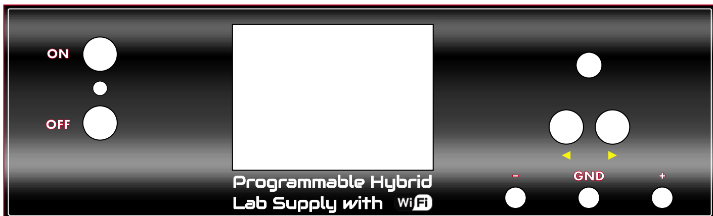
Rysunek 15. Grafika panelu przedniego urządzenia w 75% naturalnej wielkości – innymi słowy, przed skopiowaniem należy ją powiększyć do 133% wydrukowanego rozmiaru. Alternatywnie, wzór panelu można pobrać w pełnym rozmiarze ze strony internetowej Silicon Chip-a, aby wydrukować wysokiej jakości wersję do naklejenia na przyrząd
