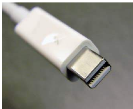
Kabel Thunderbolt 1/2 wykorzystuje to samo złącze co Mini DisplayPort i zastępuje złącze FireWire w komputerach Apple. Łączy on sygnały PCI Express i DisplayPort oraz zapewnia zasilanie prądem stałym (fot. https://w.wiki/o26 )
