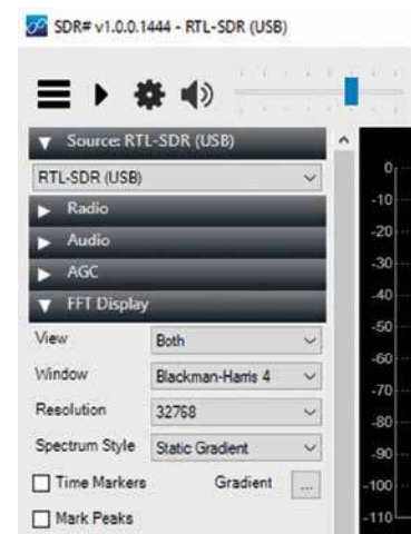
Rys. 4b. Wybór rodzaju okna (filtru) dla podłączonego odbiornika
