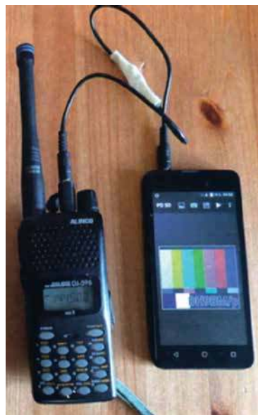
Połączenie telefonu z radiostacją
