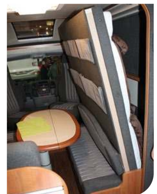
Zdjęcie nr 2 przedstawia salon w kamperze Van Exclusive 60KL z 2012 r. Wąska i niska kanapa jest odpowiednia raczej tylko dla dzieci, bo pierwszorzędnym walorem propozycji ma być uchylana ze ściany sypialnia na całej szerokości zabudowy. Skomplikowany mechanizm aranżacji takiego posłania okupiony jest także sporym balastem, więc ładowność czteroosobowego pojazdu w gotowości do jazdy to tylko 373 kg
