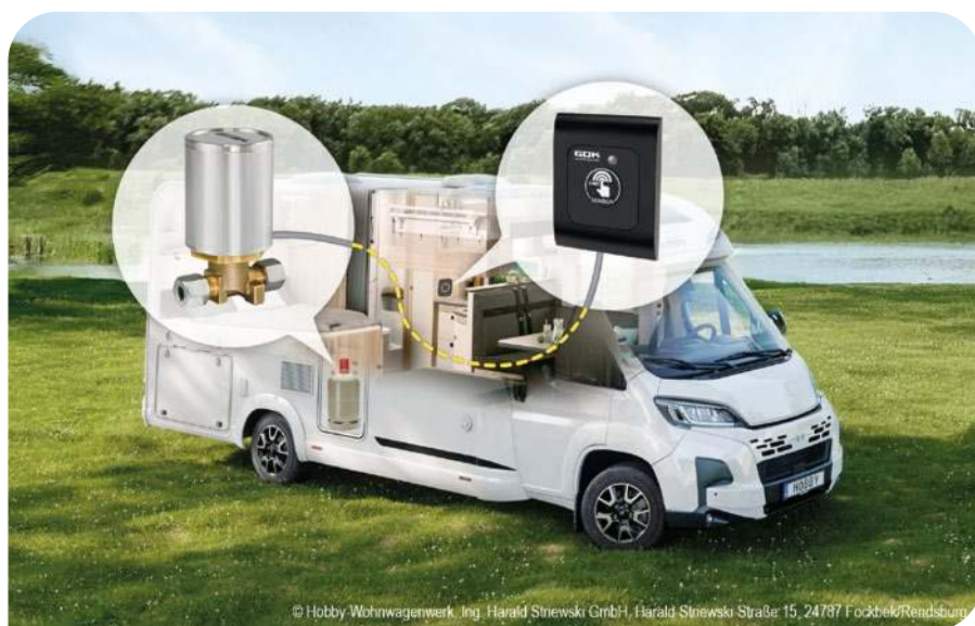
Przykład instalacji Caramatic GasControl na przewodzie niskiego ciśnienia, za reduktorem
