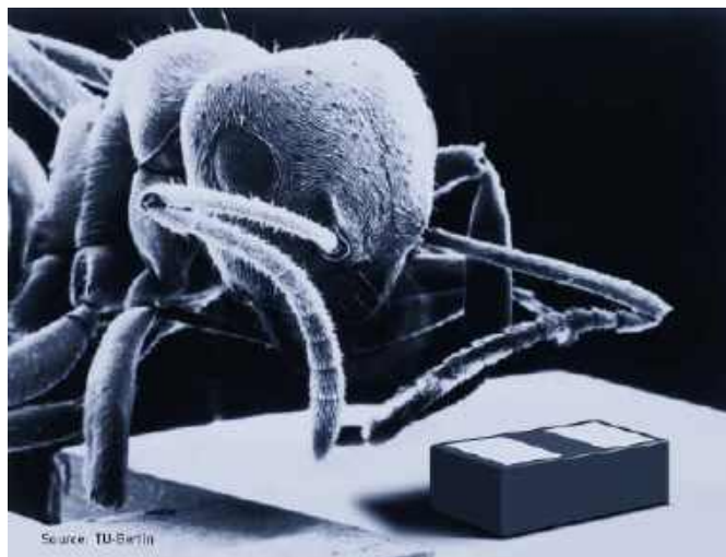
Fotografia 1. Dioda TVS o wymiarach 0,6x0,3 mm marki Infineon w porównaniu z głową mrówki ( http://t.ly/S0k6l )
