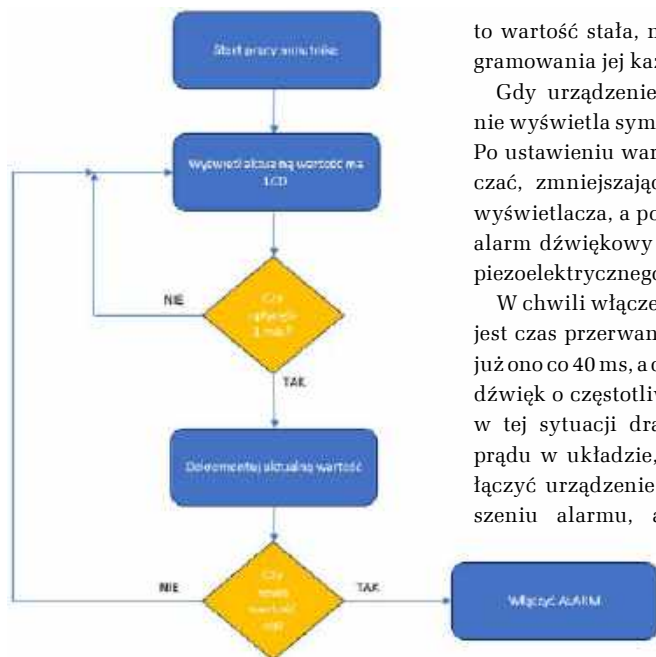
Rysunek 8. Graf algorytmu sterującego – obsługa minutnika
