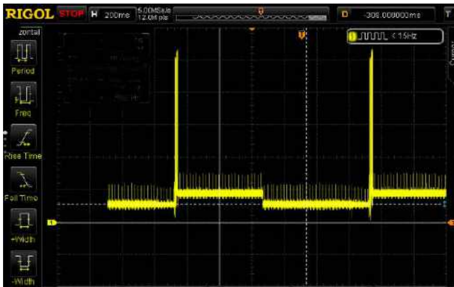
Rysunek 5. Oscylogram pokazujący przebieg prądu zasilania w trybie termometru
