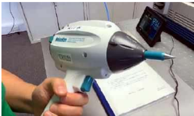
Fotografia 4. Symulator ESD z końcówką do testów metodą wyładowań kontaktowych ( http://t.ly/oEv4v )
