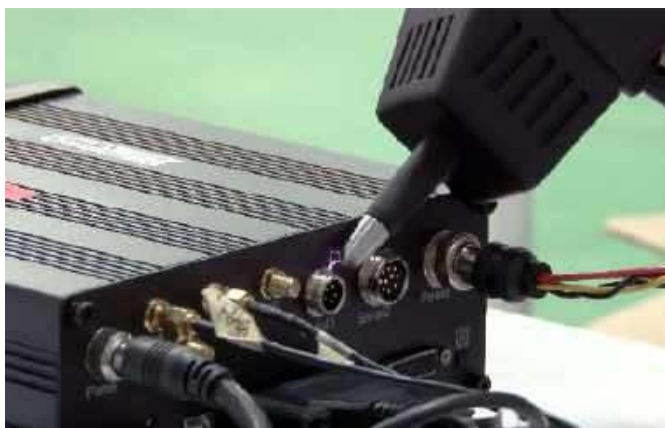
Fotografia 5. Przebieg testu wyładowania powietrznego z użyciem pistoletowego symulatora ESD ( http://t.ly/E0-20 )
