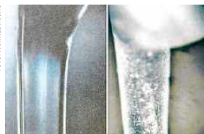
■ Włókna światłowodowe ZBLAN w porównaniu: po lewej próbka wyprodukowana w mikrogravitacji, po prawej na Ziemi. Różnica w czystości jest spektakularna.
