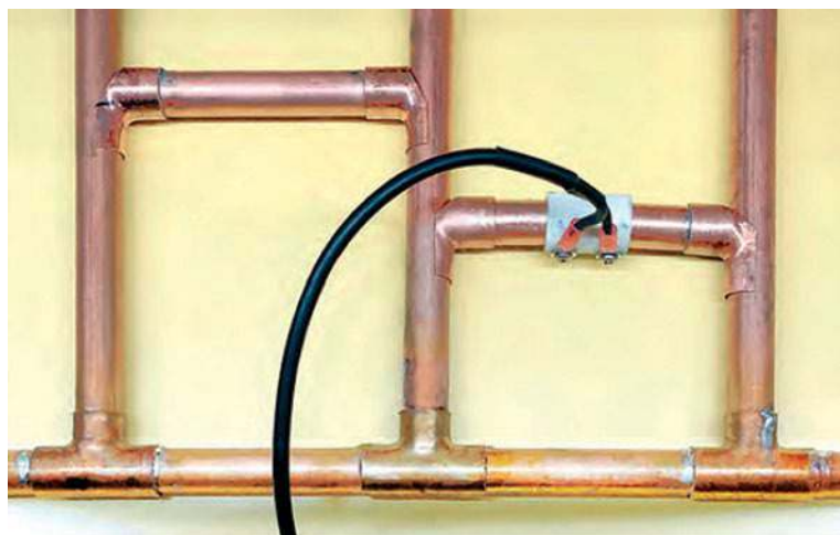
Rys. 8. Zwieracz strojeniowy po lewej i regulacja dopasowania po prawej
