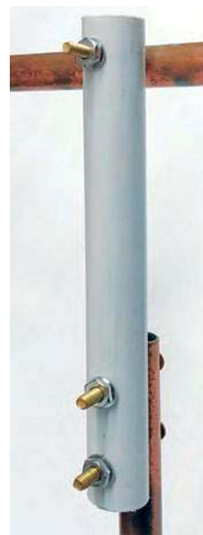
Rys. 10. Stabilizacja mechaniczna po drugiej stronie pętli
