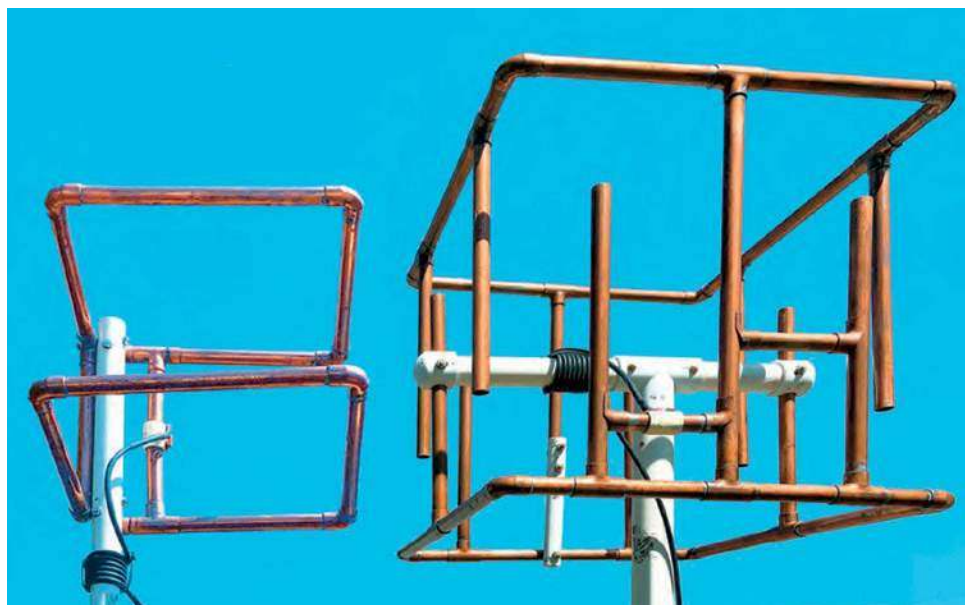
Rys. 4. Anteny szczelinowe na pasma 2 m (z lewej) i udoskonalona wersja na pasmo 6 m (z prawej)
