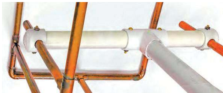
Rys. 9. Mocowanie anteny na maszcie
