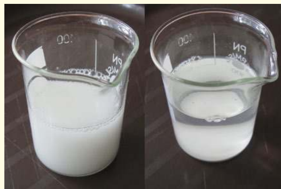
Doświadczenie 15. Wytrącenie osadu siarczanu(VI) ołowiu(II) umożliwi usunięcie ołowiu z mieszaniny poreakcyjnej.
