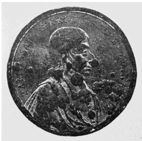
Cynowa moneta pokryta wykwitami trądu cynowego. Licencja Wikimedia Commons, ( https://commons.wikimedia.org/wiki/File:PSM_V83_D034_Two_hundred_year_old_medal_affected_by_tin_disease.png )
