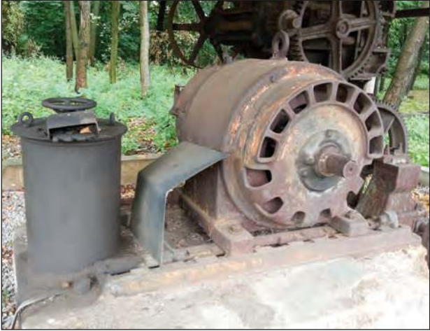
❖ Najbardziej widowiskowym przyrządem w cegielni jest maszyna do wyrobu przemysłowego. Napędzał ją włoski silnik z rozrusznikiem (do dziś posiada tabliczkę z nazwą firmy). Pochodzi z lat powojennych, a jego poprzednikiem była w tym miejscu maszyna parowa
