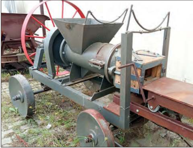
❖ Zakład nie tylko wytwarzał cegłę na skalę przemysłową. Posiadał też maszynę do domowego wyrobu tego produktu. Tak właśnie ona wyglądała. Gdy Stowarzyszenie ją pozyskało, była kupką złomu. Teraz jest odnowiona, a wiele elementów, jak np. drewniany ustnik i wózek zostało podobianych. Oryginalne są tylko główne elementy
