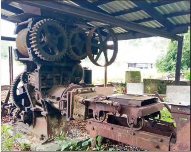
❖ Mechanizm napędzający maszynę do wyrobu cegły był skomplikowany. Zawierał wiele kół i osi. Ale co ciekawe, całość nadal jest sprawna i można ją poruszyć nawet ręką. Stowarzyszenie, aby lepiej ukazać działanie maszyny, połączy ją z silnikiem pasami transmisyjnymi
