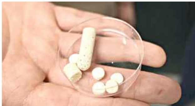
Implant polimerowo-ceramiczny ma być wszczepiany już po złamaniu i wypełniać będzie ubytek w tkance
