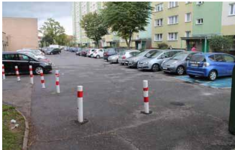
Widoczne na zdjęciu słupki poważnie utrudniają samochodom, zwłaszcza większym, jak np. karetki, wyjazd z parkingu
