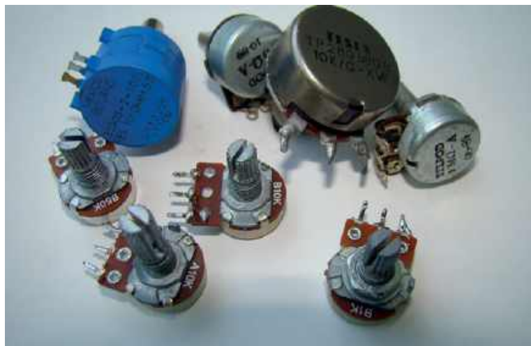
Rys. 2. Oznaczenia charakterystyki potencjometrów polskiej produkcji
