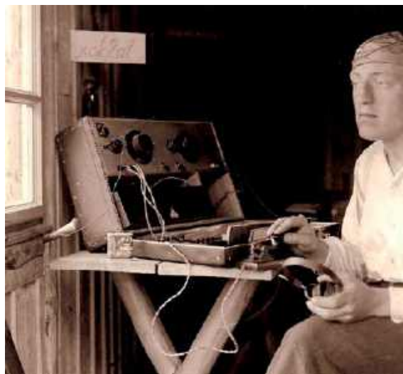
Przenośny nadajnik umieszczony w walizce. Nadawca w letniej altance
