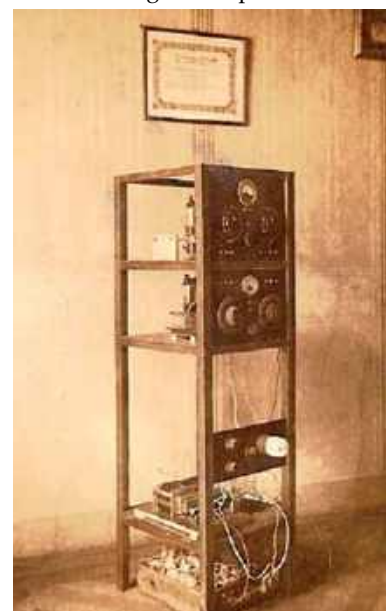
Parostopniowy stojak nadajnika EC2ET
