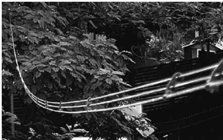
Antena hyndfed (promiennik) z użyciem dwóch linek pilotujących i uchwytów podwieszających
