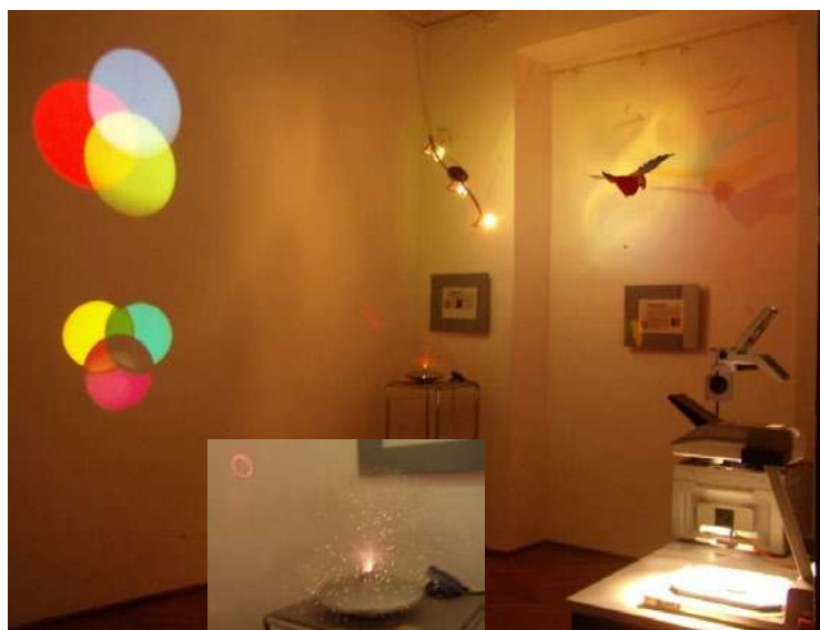
Fot. 10. Synteza kolorów. Sposób w 100% dydaktyczny to rzutnik do wykładów, z dwoma zestawami filtrów – do sumowania kolorów (obraz z lewej strony, wyżej) i ich odejmowania (obraz niżej). Po prawej o góry – kolorowe cienie – papugi wiszące pod sufitem a oświetlonej trzema kolorowymi lampami. W rogu pokoju „fontanna” światłowodów (powiększenie pokazane na wkładce) oraz figury Lisajoux z małego, laserowego rzutnika. Opisy umieszczono w ramach na ścianie. Legnica, wrzesień 2009, foto M. Karwasz.
