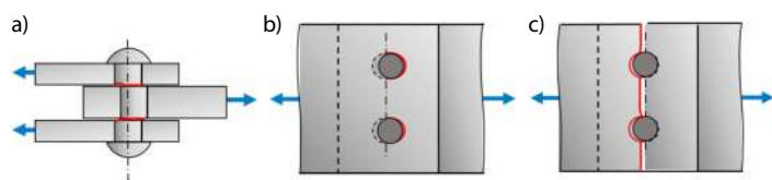
Rys. 1. Możliwe mechanizmy zniszczenia połączeń nitowych: a) ścięcie trzpieni łączników, b) uplastycznienie blachy wskutek docisku trzpienia do krawędzi otworu, c) rozerwanie elementów
