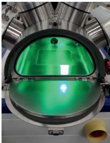
Planet Simulator na McMaster University w stanie Ontario może imitować promieniowanie różnych gwiazd, a także docierające do powierzchni różnych planet światło filtrowane przez ich atmosfery, by badać prawdopodobieństwo powstania tam życia.
