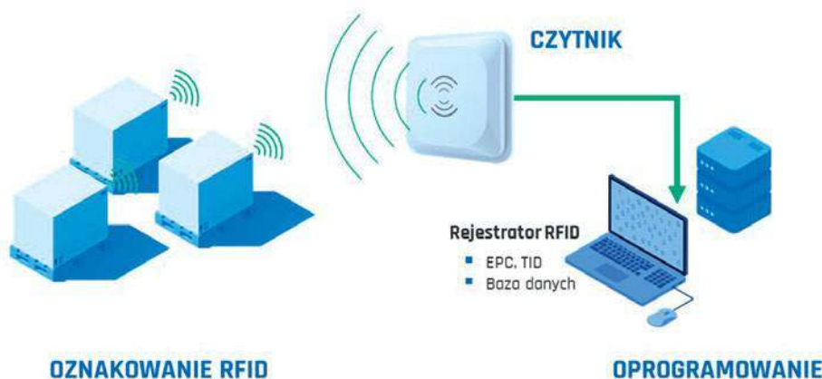
Rys. 1. Zasada działania RFID
