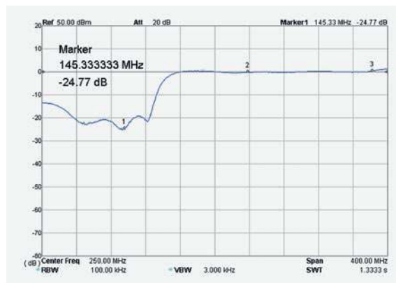
Rys. 6. Wynik pomiaru tłumienia fali odbitej na wejściu wzmacniacza przy 145 MHz
