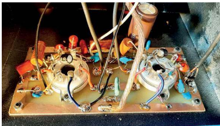
Widok montażowy elementów przy gniazdach lamp i płytka PCB
