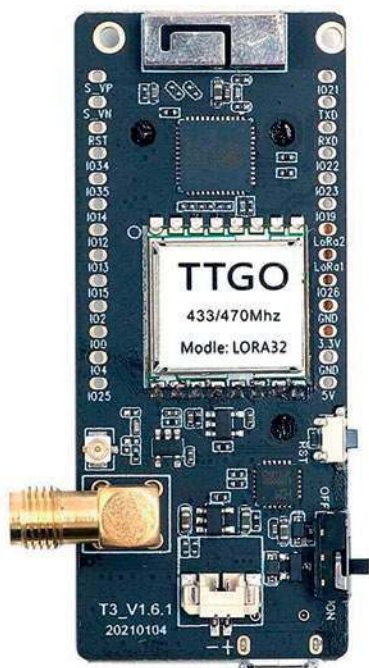
Fot. 2. Moduł DollaTek LoRa433 bez odbiornika GPS
