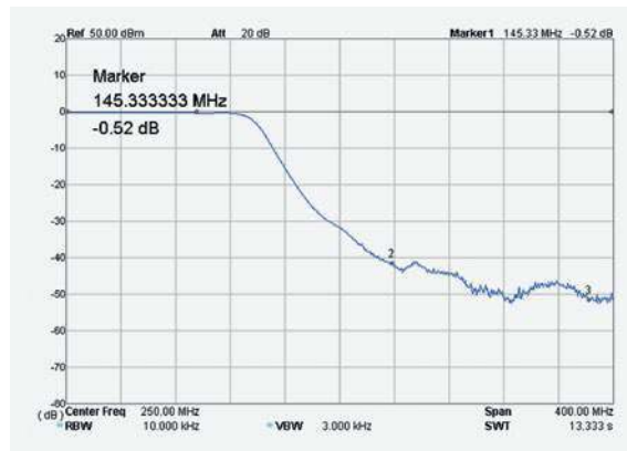
Rys. 5. Charakterystyka tłumienia filtru dolnoprzepustowego
