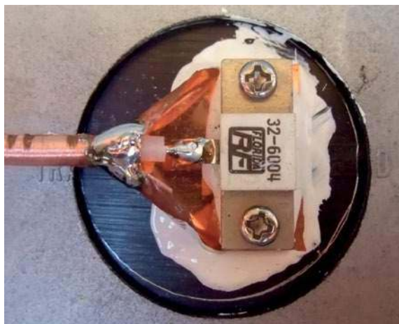
Sposób zamontowania rezystora
