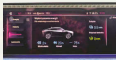
Menu napędu pozwala szczegółowo analizować zużycie energii.
