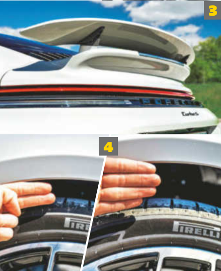
Przednie opony mają rozmiar 265/35 ZR20, co oznacza, że są wyraźnie mniejsze niż tylne (325/30 ZR21).
