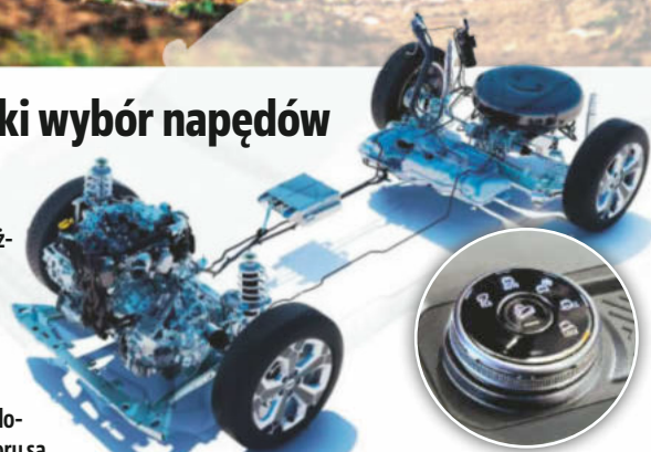
Wyjątkowe rozwiązanie: dwupaliwowy układ MHEV z napędem na 4 koła.
