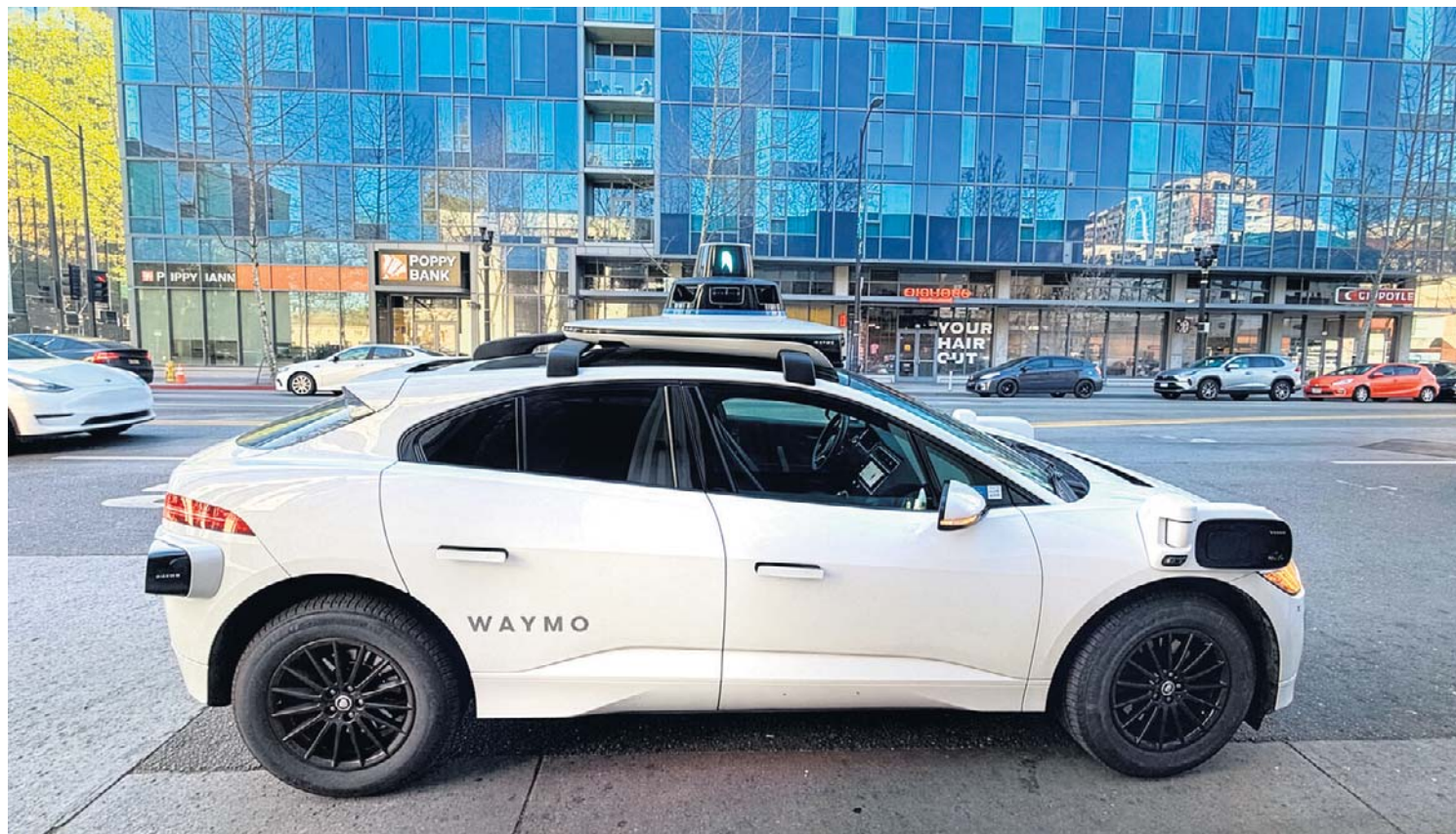
Autonomiczny Jaguar I-PACE z technologią Waymo, to wyposażona w 29 kamer elektryczna taksówka bez kierowcy, oferująca przejazdy m.in. w San Francisco, Los Angeles, Phoenix i Austin. Do końca 2026 roku planują posiadać flotę 6 tys. pojazdów
