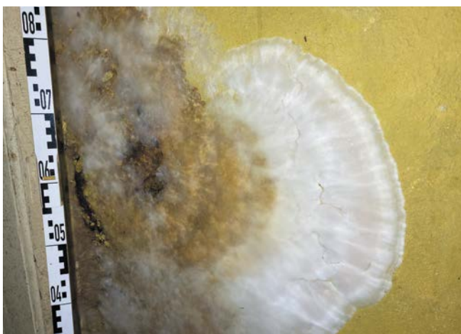
FOT. 4 Grzybnia przerosnięta sznurami grzybnii, z oliwkowymi przebarwieniami; fot.: autor
