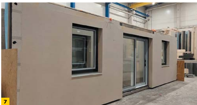
FOT. 7–8 Przykładowe prefabrykowane ściany z drewna; fot.: [8, 9]
