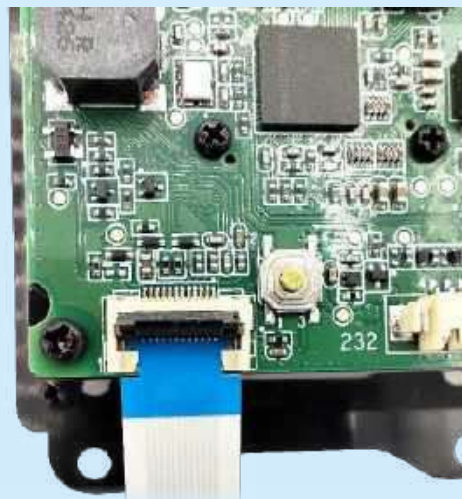
Fotografia 8. Prawidłowo umieszczona końcówka przewodu FPC w złączu ZIF modułu skanera. Montując przewód, należy zwrócić uwagę, czy wycięcia w usztywniaczu trafiły na specjalnie przewidziane do tego celu miejsce wewnątrz gniazda ZIF
