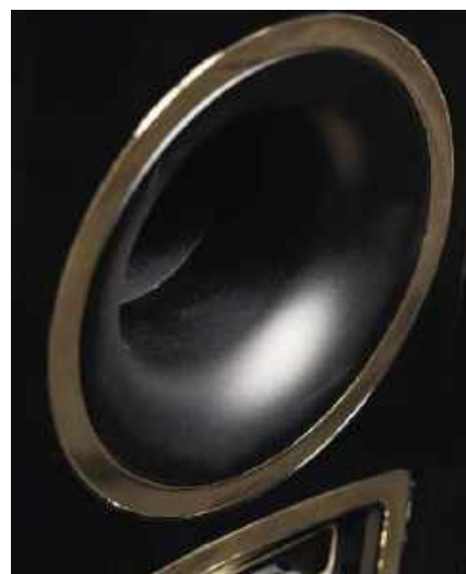
Znaleźliśmy tylko ten jeden tunel bas-refleks, ale głośniki niskotonowe zachowują się tak, jakby pracowały w różnych systemach rezonansowych (co nie ma wiele wspólnego z ich różnym filtrowaniem w zwrotnicy).
