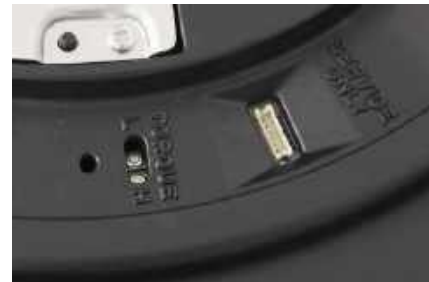
Pod talerzem znajduje się przełącznik szybkości rozkręcania talerza (trzy warianty).
