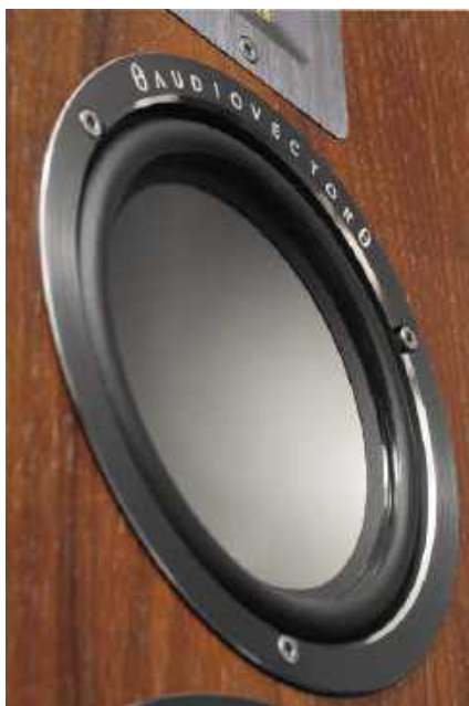
16-cm głośnik średnionowy ma membranę jednoczęściową, ale wielowarstwową. Jest dość nietypowo filtrowany górnoprzepustowo – częstotliwość podziału (z niskotonowymi) jest wysoka, ale zbocze poniżej łagodne, aż do zaznaczonego rezonansu przy 80 Hz.
