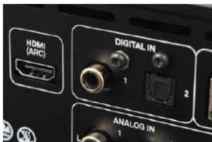
Sprzęt stereo jest coraz częściej wyposażany w złącze HDMI (z ARC), co pozwala łączyć go z telewizorami.
