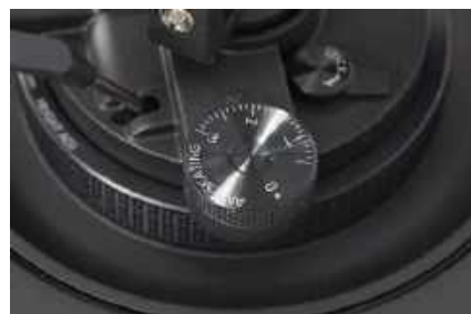
Anti-skating wygodnie regulujemy pokrętką na bocznej platformie.
