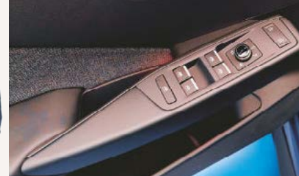
Zamiast dwóch przycisków szyb i przełącznika ka przód/tył teraz są cztery przyciski.
